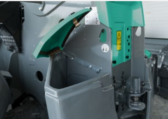
Tárolórekesz a hátsó súlyokban a KT457 –KT559 modellekhez
