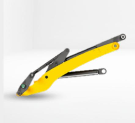
L'unità di carico a guida parallela assicura una forza di sollevamento costante e un uso sicuro durante la movimentazione di materiale. Con un angolo di inclinazione all'indietro fino a 45° e un angolo di scarico fino a 45°, la pala gommata non perde materiale nell'inserito della benna, anche con un livello di riempimento elevato
