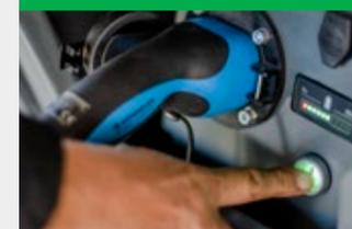
Premere il pressostato\* per avviare il processo di ricarica. L'indicatore dello stato di carica nella parte posteriore della macchina inizia a lampeggiare.
