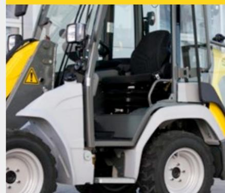
L'ampia salita, compreso un ulteriore gradino, garantisce una salita e un'uscita confortevoli. Due maniglie attaccate alla cabina aiutano l'operatore a raggiungere in sicurezza la sua postazione di lavoro. Inoltre, la porta della cabina può essere aperta di 180 gradi e bloccata sulla macchina.
