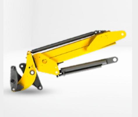
Il design compatto della scatola del sistema di caricamento telescopico rende la vista dell'attrezzatura unica. Vantaggi della cinematica Z: durante il carico della benna, con le stesse dimensioni dei cilindri si ottiene una forza di strappo maggiore in quanto il lato del pistone del cilindro idraulico viene sollecitato durante il carico.
