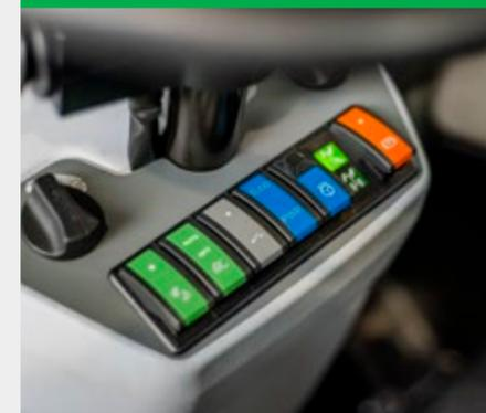
Le due modalità di guida, Eco e Power (PWR), possono essere impostate con un interruttore basculante. La modalità Eco, tra le altre cose, consente di ridurre la velocità di guida a un massimo di 14 km/h. Ciò significa che l'operatore risparmia energia e guadagna autonomia supplementare. Con la modalità PWR, il veicolo gode della piena potenza. La velocità massima di guida è di 20 km/h.
