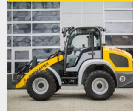
Le macchine offrono le migliori condizioni per un'altezza libera ridotta. Tutte le macchine hanno un'altezza totale inferiore a 2,5 m. La struttura compatta della pala gommata 5050 consente un trasporto semplice su un rimorchio da 3,5 t.
