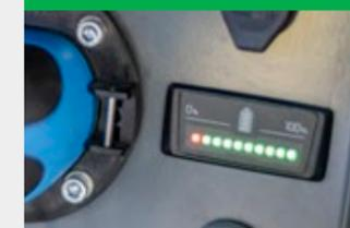
L'indicatore del livello di carica si accende fisso non appena il processo di ricarica si conclude automaticamente.
