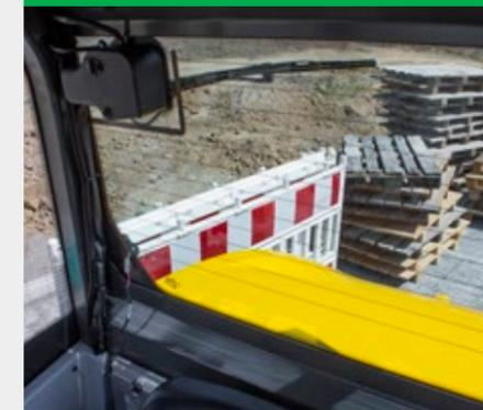
La cabina con una visuale libera e il montante B posizionato in modo ottimale garantiscono un'eccellente visibilità panoramica. Un parabrezza panoramico è disponibile di serie. Il vano batteria appiattito e abbassato garantisce un'eccellente visibilità posteriore. Nella parte centrale del cofano è presente un'aletta, che consente un orientamento migliore in retromarcia.
