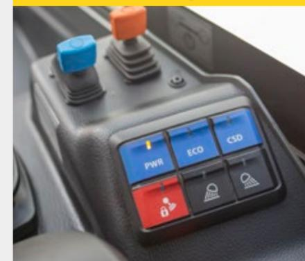
La caratteristica del modello 5040 include tre modalità di guida che possono essere modificate premendo un pulsante, per soddisfare i rispettivi requisiti nel modo più efficiente possibile. La modalità Power (PWR) è adatta ai lavori con la benna, la modalità ECO è più idonea ai lavori di accatastamento o guida su strada, mentre il dispositivo di marcia lenta (CSD) per l'impiego di attrezzi idraulici.
