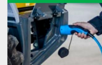
Premere il pressostato\* e rimuovere la presa di ricarica. Quindi chiudere la console di ricarica e riporre il cavo di ricarica.
