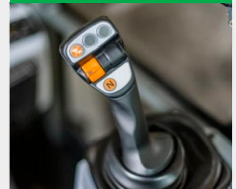
Sul joystick è integrato il pulsante per le due marce: tartaruga e lepre. L'operatore può regolare comodamente in qualsiasi momento la velocità di marcia massima. Commutazione possibile durante la guida. Sul display viene visualizzato il simbolo della marcia rispettiva. La velocità di marcia massima dipende anche dalla rispettiva modalità di marcia.
