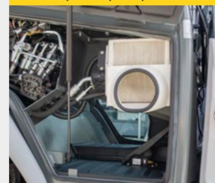
Lo sportello per la pulizia si trova sul lato destro della cabina. Lo sportello può essere aperto dal basso verso l'alto tramite una maniglia ed è fissato con un ammortizzatore. Ciò fornisce un facile accesso al filtro dell'aria della cabina e all'unità di comando principale. La pulizia del pavimento della cabina può essere eseguita con tanta facilità.
