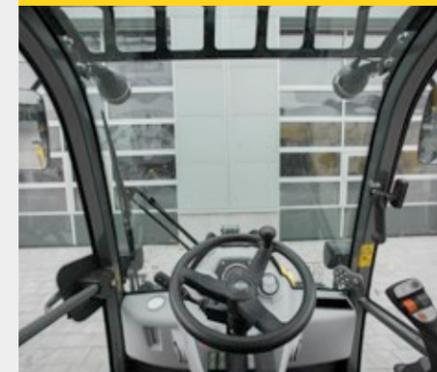
La posizione del sedile dell'operatore centrale offre una visibilità panoramica a 360°. La struttura particolarmente chiara evita "punti ciechi". Massima visibilità anche nella parte posteriore. Anche con l'unità di carico telescopica estesa sul 5065T, l'operatore ha una visuale perfetta dell'accessorio.
