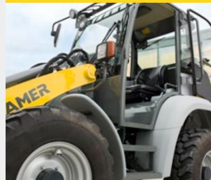
La cabina di guida è raggiungibile attraverso l'ampia area di ingresso. Grazie al telaio del veicolo indiviso, è possibile anche un facile accesso con il massimo angolo di sterzata. La salita è strutturata come una scala. Per facilitare la salita e la discesa dal veicolo dell'operatore in sicurezza, le maniglie sono in una posizione ergonomicamente favorevole.
