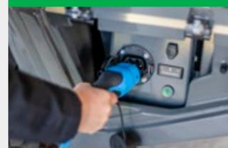
Aprire la console di ricarica e collegare il cavo di ricarica alla macchina.
