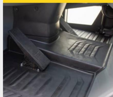
Il trafofo centrale nel pavimento della cabina è alto solo 5 cm grazie al design del telaio del veicolo. Ciò consente la salita e la discesa comoda dell'operatore. Inoltre, il trafofo centrale è ricoperto da un tappetino in gomma e può essere pulito facilmente.
