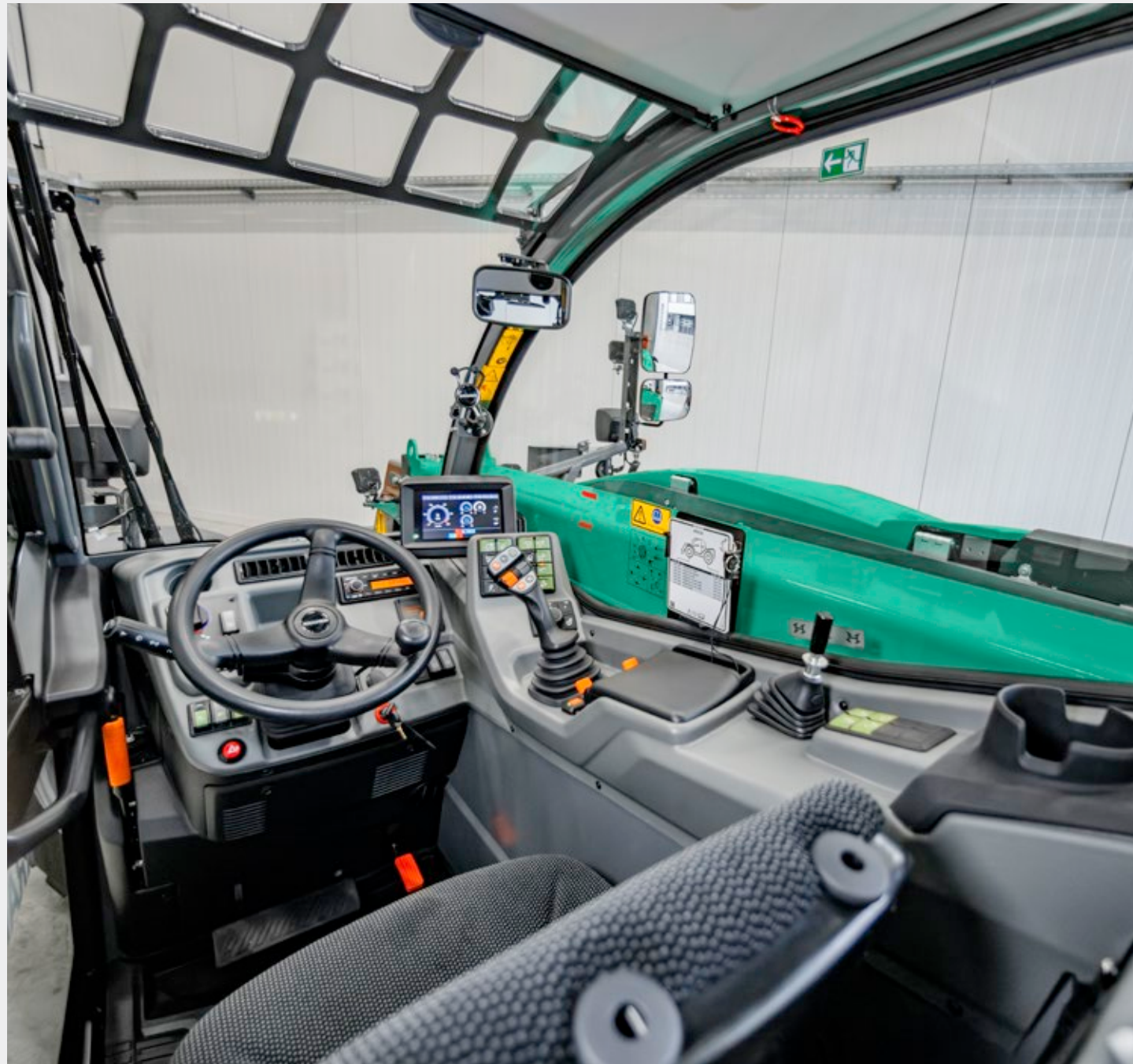
Godt udsyn til højre på grund af det store vindue i højre side og teleskopbommens lave position.
