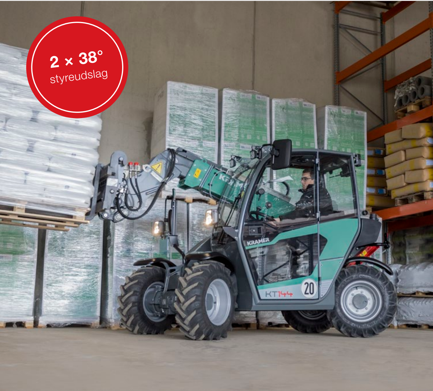
Firehjulsstyring: særligt manøvredegtigt under trange pladsforhold
