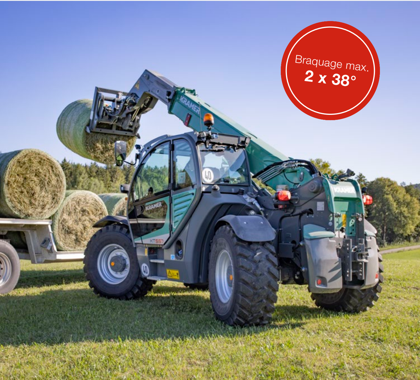
Quatre roues directrices pour une maniabilité maximale
