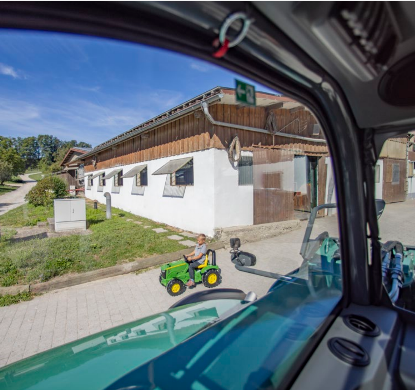
Le capot plat assure une visibilité optimale sur le côté droit.
