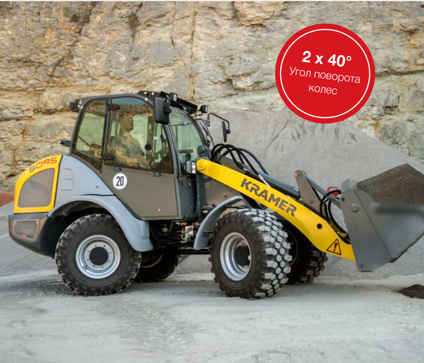
Рулевое управление всеми колесами – особенно высокая маневренность в стесненных условиях
