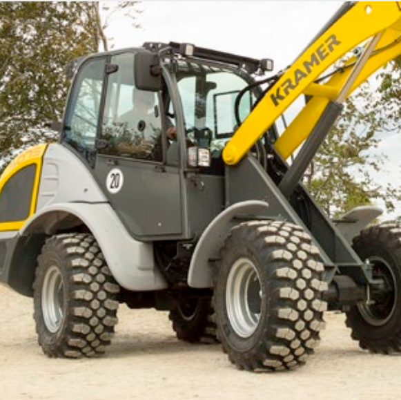
Режим «крабьего» хода для точного позиционирования
