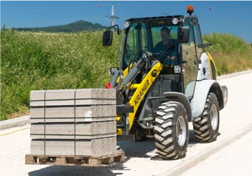
Управление передними колесами для повышенной безопасности во время быстрой транспортировки
