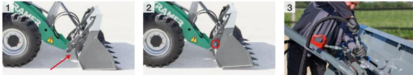
L'attache rapide hydraulique permet de changer d'équipement très simplement depuis la cabine. L'actionnement de l'axe de verrouillage se fait en actionnant un bouton sur le joystick. Lors du changement d'équipement nécessitant une fonction hydraulique supplémentaire, l'opérateur doit descendre de la machine pour raccorder manuellement les flexibles.
