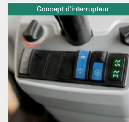
Le marquage couleur des interrupteurs permet d'identifier chaque groupe de fonctions très rapidement. Rouge = sécurité, Vert = hydraulique, Bleu = conduite et Gris = électrique. Le conducteur dispose ainsi de conditions de pilotage confortables et sûrs, sans risque de confondre les boutons. Le résultat ? Une meilleure efficacité de travail du conducteur.
