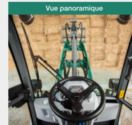
La position centrale du siège conducteur offre une visibilité panoramique à 360°. Le design bien dégagé de la machine permet d'éviter les angles morts. Tout reste à portée de vue, même à l'arrière. Même avec le bras chargeur de la KL25.5T déployé, l'opérateur conserve une vue parfaite sur l'équipement.
