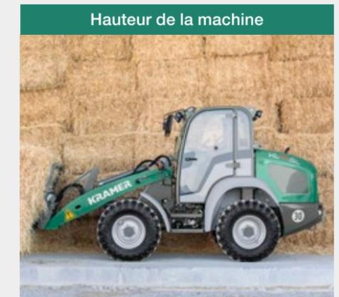
Les machines offrent les meilleures caractéristiques pour travailler dans les passages bas. Toutes les machines mesurent moins de 2,5 m de haut. La structure compacte de la chargeuse sur pneus KL18.5 permet un transport en toute simplicité sur une remorque 3,5 t.
