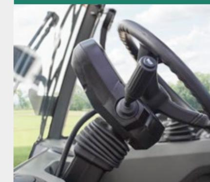
La colonne de direction inclinable en option est adaptable aux besoins du conducteur. Le volant est constitué d'un matériau de haute qualité et facile à saisir. En outre, un écran d'affichage moderne avec retour automatique du clignotant se trouve sur la colonne de direction.
