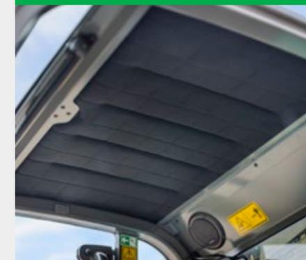
Outre le chauffage soufflant, la cabine dispose d'un chauffage de vitre avant et arrière économe en énergie en option qui permet d'économiser de l'énergie, d'un siège chauffant et d'un chauffage par rayonnement. Cela permet de chauffer des zones ciblées plutôt que tout le volume de l'habitacle. Le chauffage par rayonnement se trouve dans le toit de la machine et sous le siège conducteur. La cabine est en outre bien isolée à l'aide de tapis isolants afin de ne pas perdre de chaleur.
