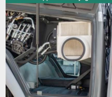
La trappe de nettoyage se trouve sur le côté droit de la cabine. La trappe peut être ouverte avec une poignée d'un bas vers le haut et est fixée par un amortisseur. Cela permet d'accéder facilement au filtre à air de la cabine et à l'unité de commande principale. Le plancher de la cabine peut être très facilement nettoyé.
