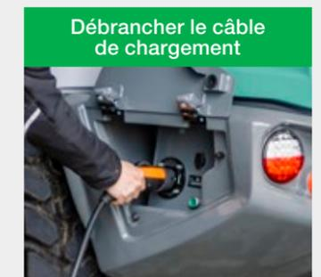
Actionner l'interrupteur de pression\* et débrancher le connecteur de charge. Ensuite, fermer la console de charge et ranger le câble de chargement.
