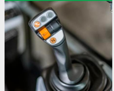
La sélection des deux réglages de la vitesse est intégrée sur joystick. Tortue et Lièvre. Le conducteur peut à tout moment adapter confortablement la vitesse maximale en conduisant. Le symbole du réglage de la vitesse correspondant est affiché à l'écran.
