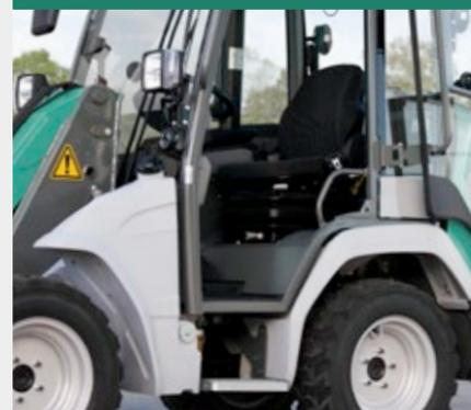
Le large accès avec un marche pied supplémentaire assure une montée et une descente confortables. Deux poignées montées sur la cabine aident l'opérateur à se hisser sur son siège de travail en toute sécurité. De plus, la porte de la cabine peut être ouverte à 180 degrés et verrouillée sur la machine.
