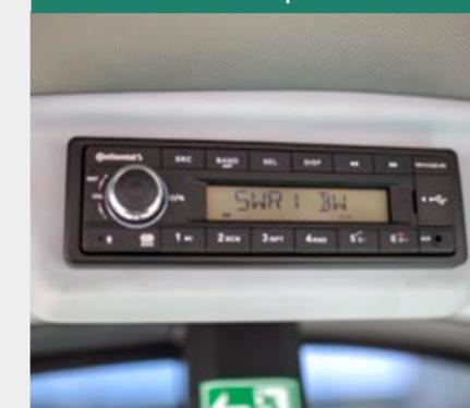
Une radio Continental avec prise USB et système mains libres Bluetooth est disponible en option. Les réglages de température et de ventilateur sont situés dans la console latérale. Le climatiseur en option pour la KL14.5 assure une atmosphère agréable, même les jours de fortes chaleurs. De plus, le véhicule peut être équipé d'un arrêt automatique du moteur via le contact du siège.
