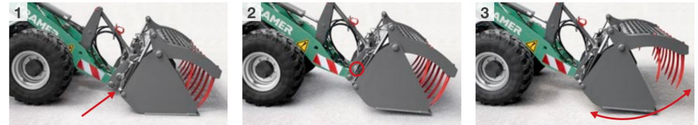
Smart Attach est une attache rapide hydraulique combinée à un système de raccordement automatique conçue par Kramer. Le raccordement manuel des flexibles hydrauliques n'est plus nécessaire et l'opérateur n'a plus besoin de quitter la machine. La commande se fait comme d'habitude sur le joystick, directement depuis la cabine.
