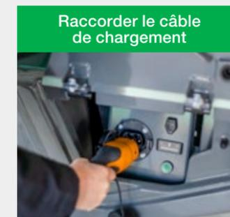
Ouvrir la console de charge et raccorder le câble de chargement à la machine.
