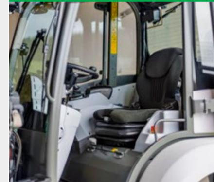
La cabine est accessible facilement et confortablement par une zone d'accès large. Celle-ci comprend deux marches de belle taille disposées en escalier. Elles sont antidérapantes pour garantir la sécurité du conducteur par tous les temps. Les poignées sont installées dans une position bien accessible où elles sont faciles à saisir.
