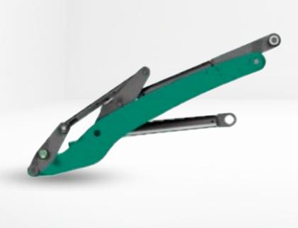
L'installation de chargement orientée en parallèle garantit une force de levage constante et une utilisation en toute sécurité lors du transport de matériaux. Grâce à l'angle de cavage jusqu'à 45°, le godet de la chargeuse sur pneus ne laisse échapper aucun matériau, et ce même lorsque le godet est complètement rempli. L'angle de déversement jusqu'à 45° permet quant à lui de vider complètement le godet.
