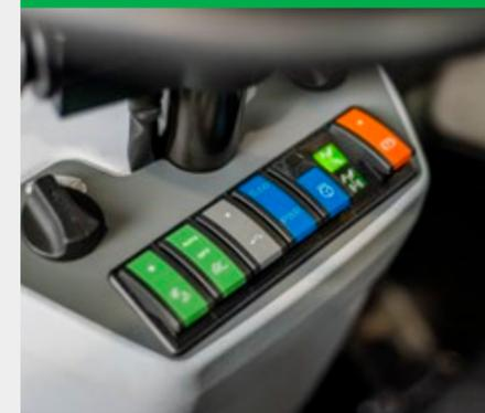
Les deux modes de conduite Eco et Power (PWR) peuvent être sélectionnés via un interrupteur basculant. En mode Eco, la vitesse est notamment réduite à 14 km/h. Le conducteur peut ainsi économiser de l'énergie et gagner de la durée de service. En mode PWR, la machine utilise toute sa puissance. La vitesse d'avancement s'élève au maximum à 20 km/h.
