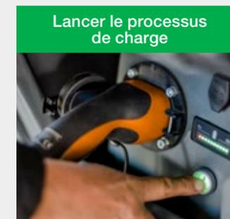
Actionner l'interrupteur de pression\* pour lancer le processus de charge. L'indicateur d'état de charge qui se trouve à l'arrière de la machine commence à clignoter.
