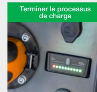
L'indicateur d'état de charge s'allume en continu dès que le processus de charge est arrêté automatiquement.
