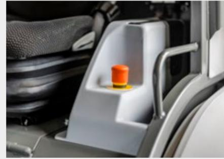
**Interrupteur d'arrêt d'urgence rapidement accessible,** afin de pouvoir mettre la machine immédiatement dans un état sûr en cas de danger.
