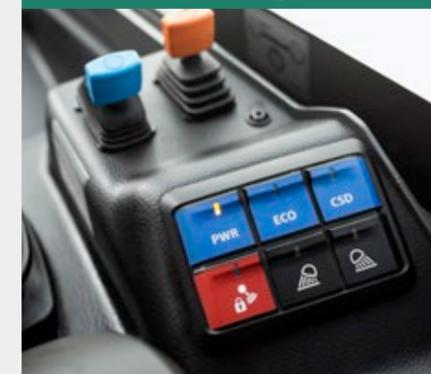
Cette fonction de la KL14.5 comprend trois modes de conduite à sélectionner d'une pression de bouton pour répondre de la façon la plus efficace aux différentes situations. Le mode Power (PWR) convient pour les opérations avec godet, le mode ECO est adapté aux travaux de gerbage et à la circulation sur route, tandis que le mode pédale d'accélérateur (CSD) est idéal pour l'utilisation d'équipements hydrauliques.
