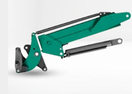
La conception robuste et modulaire de l'installation de chargement télescopique offre une excellente visibilité sur l'équipement. Les avantages de la cinématique en Z : lors du redressement du godet, une plus grande force d'arrachement est obtenue pour la même taille de cylindre, car le côté piston du vérin hydraulique est alimenté en pression lors du redressement.
