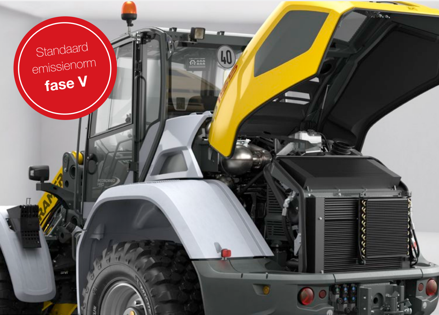
Watergekoelde 4-cilinder in-line-motor met gekoelde externe uitlaatgasretourleiding, turbolader en interkoeler.
