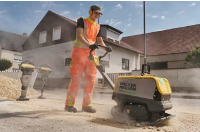
Na jednym ładowaniu akumulatora APU3050e zagęszcza do 333 m² gruntu*.
