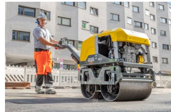
Długi dyszel ułatwia kierowanie i obracanie, szczególnie na małych powierzchniach.
