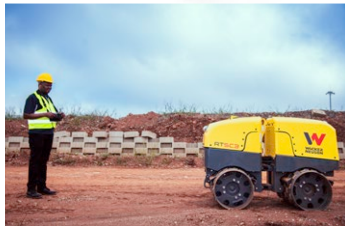
Bezpieczeństwo obsługi: czujnik zbliżeniowy między operatorem i maszyną automatycznie dezaktywuje maszynę w obszarze 2 m.
