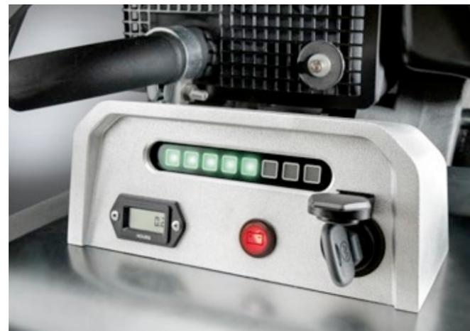
**Verdichtungsanzeige Compatec:** Sie zeigt an, wenn die maximale Verdichtung mit einem Gerät erreicht ist. Mehr erfahren Sie auf: [www.wackerneuson.com/compatec](http://www.wackerneuson.com/compatec)
