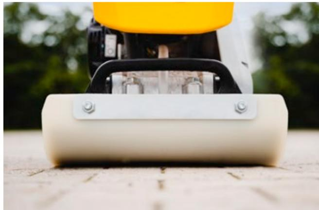
Die Pflastergleitvorrichtung (Zubehör) schützt empfindliche Pflasteroberflächen beim Einrütteln. Mit nur zwei Schrauben ist sie schnell am Gerät befestigt.
