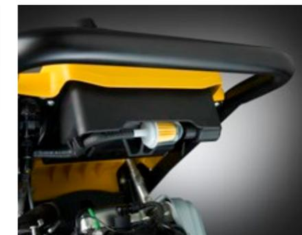
Durch den transparenten Kraftstofffilter im Sichtbereich des Bedieners kann der Kraftstofffluss leicht überprüft werden.
