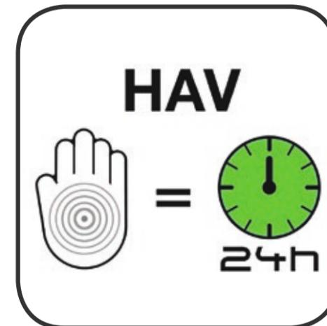
**Keine Dokumentationspflicht:** Hand-Arm-Vibrationen (HAV) liegen unter 2,5 m/s<sup>2</sup> dank schwingungsreduzierter Deichsel.
