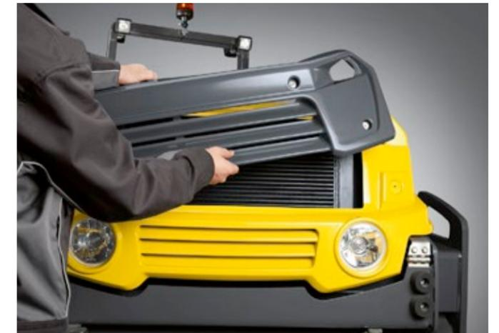
**Einfache Kühlerreinigung** durch separat abnehmbare Klappe.
