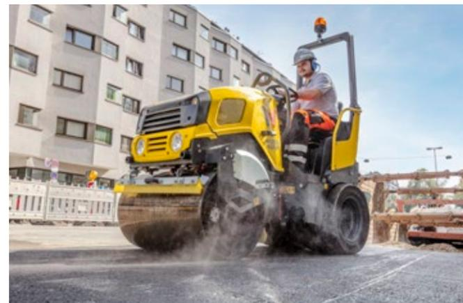
**Taillierte Bauform:** für freien Blick auf die Bandagenkanten, das Maschinenumfeld und die Baustelle.
