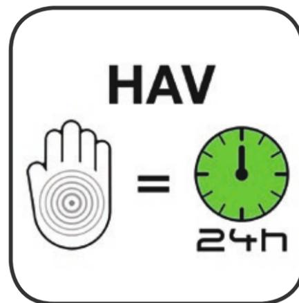
Die Hand-Arm-Vibrationen (HAV) liegen dank schwingungsreduzierter Deichsel unter 2,5 m/s<sup>2</sup>, damit entfällt die Dokumentationspflicht
