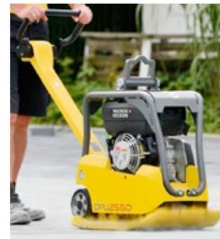
Top-Speed-Version: für hohe Flächenleistung beim Pflasterstein-einbau.
