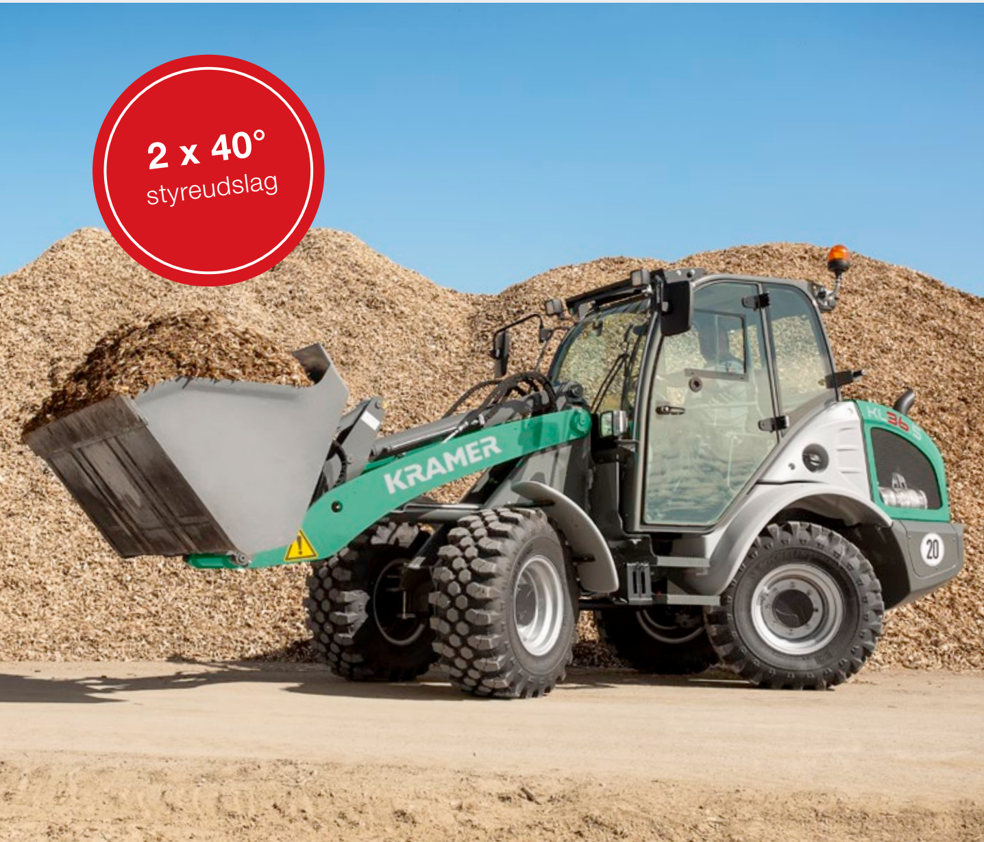
Firehjulsstyring giver særdeles god manøvreringsdygtighed på selv trange steder
