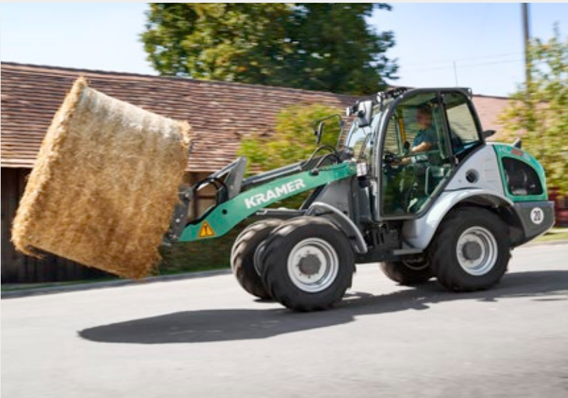
Forakselstyring for bedre stabilitet under hurtige transportture
