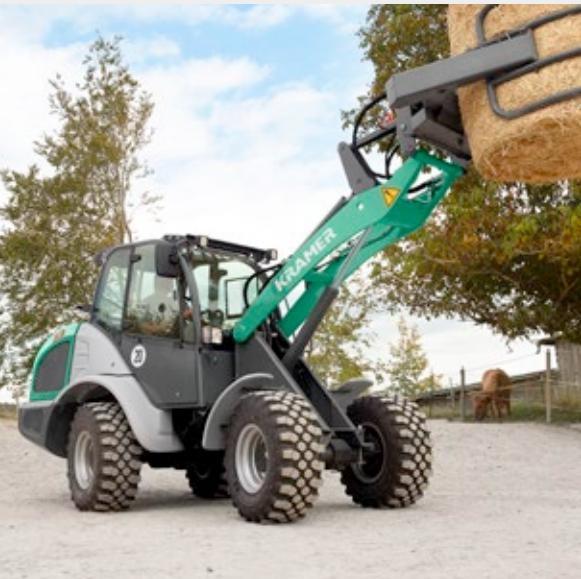
Krabbestyring for præcis positionering
