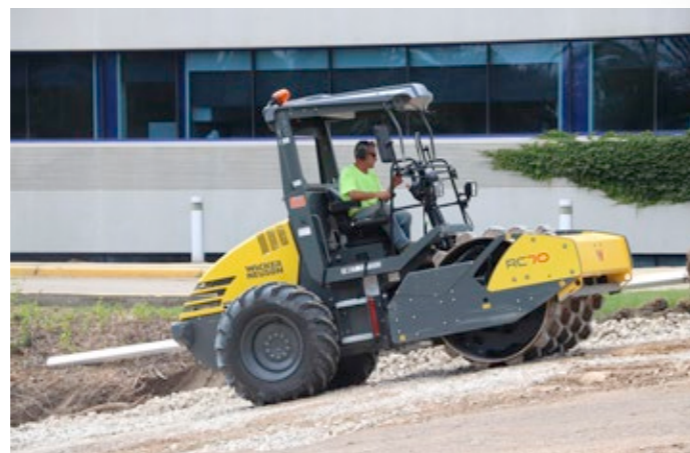
Antislirstyrningen ser till att hjulen inte slirar, inte ens i ojämn terräng.
