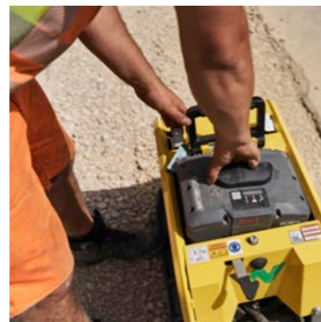
Batteriet byts med ett par handgrepp.
