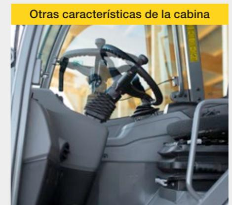
El amplio equipamiento estándar incluye, entre otras cosas, la columna de dirección de inclinación ajustable, que se puede ajustar individualmente. Además, el espejo retrovisor y las cuatro luces de trabajo ofrecen una línea de visión óptima. El vehículo puede equiparse opcionalmente con un asiento del operador con suspensión neumática, soporte lumbar y asiento calefactado.
