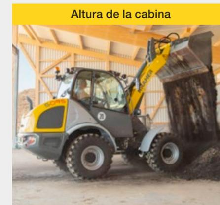
El diseño compacto y bajo de las cargadoras sobre ruedas de menos de 2,50 m permite un trabajo ideal de las máquinas en obras con poco espacio. Las máquinas ofrecen un diseño idóneo para los pasos de baja altura gracias a su diseño.
