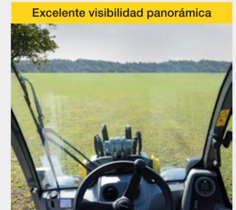
La posición central del asiento junto con las grandes ventanas acristaladas ofrecen una visibilidad de 360° en todas las direcciones. El diseño especialmente distribuido y la posición del asiento del operador evitan los «puntos ciegos». Incluso permiten ver todo lo que hay en la parte trasera. El parabrisas elevado permite una visibilidad perfecta del implemento, incluso cuando el brazo está levantado.
