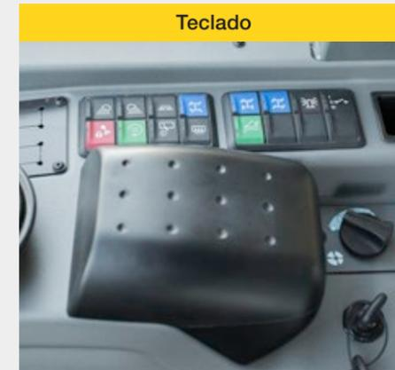
El grupo funcional correspondiente es muy rápido y fácil de identificar gracias a los interruptores codificados por colores. Rojo = seguridad, verde = hidráulica, azul = desplazamiento y gris = sistema eléctrico. Esto garantiza al operador un manejo cómodo y seguro sin riesgo de confusión. El resultado es una mayor eficiencia en el trabajo.
