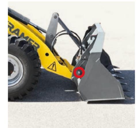
**Sistema de cambio rápido hidráulico - El sistema de enganche rápido de Kramer:** acérquese al implemento, levante el implemento de forma hidráulica desde el asiento del operador y bloquéelo con el deslizador táctil del joystick. El cilindro de la cerradura se encuentra fuera del punto de pivote de la placa de acople rápido y, por lo tanto, no está en la zona de contaminación.
