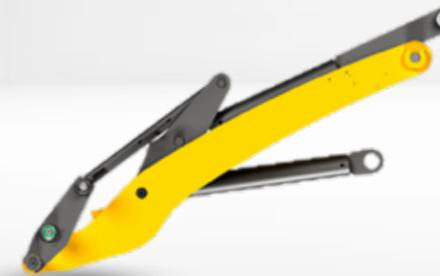
El sistema de carga de control en paralelo garantiza una fuerza de elevación constante y un manejo seguro en la manipulación de materiales. Debido al elevado ángulo de inclinación hacia atrás de 50° y al ángulo de inclinación hacia fuera de 45°, la cargadora no pierde ningún material de la cuchara, incluso cuando está muy llena, lo que permite un vaciado completo de la cuchara.
