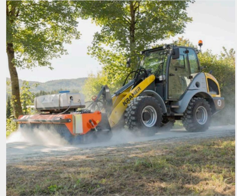
**CSD - constant travel speed (velocidad de desplazamiento constante):** ayuda a mantener la velocidad establecida, sobre todo cuando se utilizan implementos en los que se requiere una velocidad constante para la correcta ejecución del trabajo, como quitanieves, barredoras giratorias o desbrozadoras.
