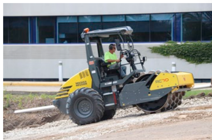
Il controllo della trazione garantisce che le ruote non slittino neanche su terreni irregolari.
