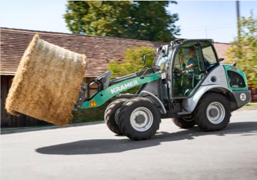
Esirataste roolimine suurendab stabiilsust kiiretel transpordisõitudel
