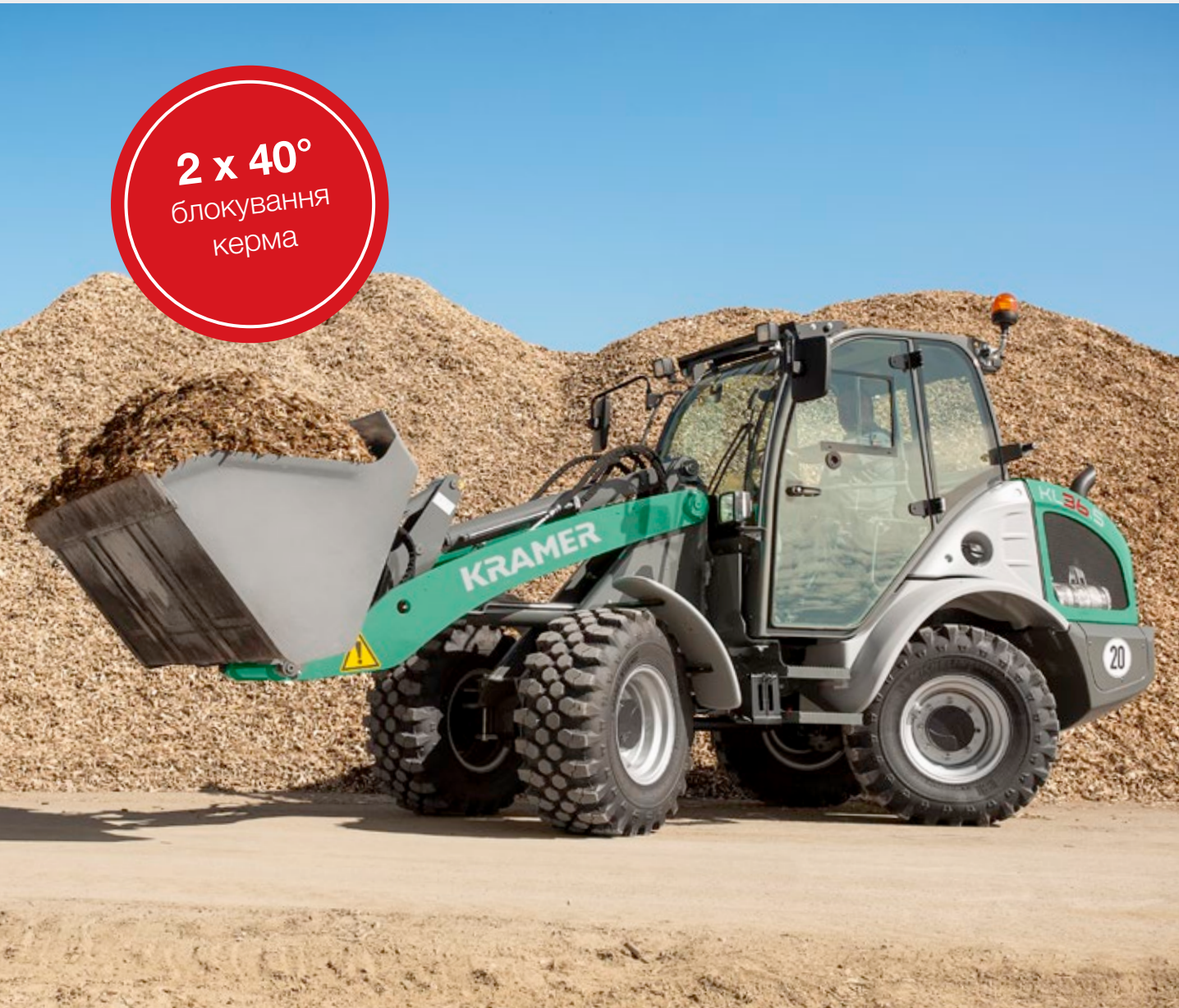
Повнопривідна система управління є надзвичайно маневреною у найменшому просторі
