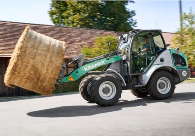
Керування передньою віссю для підвищення стабільності під час швидких транспортних поїздок
