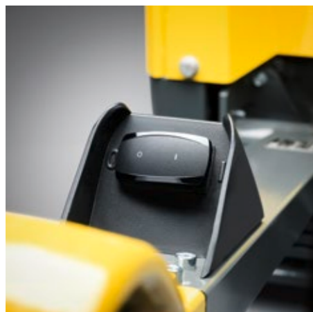
De schakelaar is voor de bediener goed toegankelijk op de stuurbeugel aangebracht.
