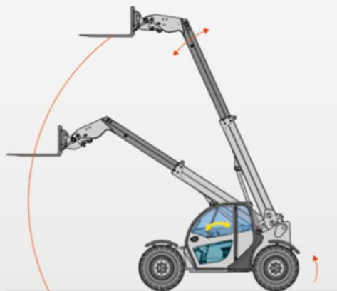
**Con vls.** Movimiento casi vertical. Apenas hay un desplazamiento del par de carga en la dirección longitudinal de la máquina.
