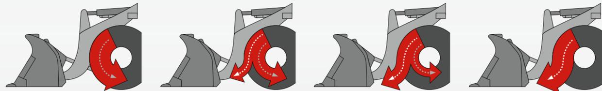
1. Mancanza di pressione sul pedale freno/inching: piena potenza per il sistema di trazione.
