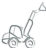
Teleskophjullæsser Skovlindhold: 0,65 - 1,45 m 3
