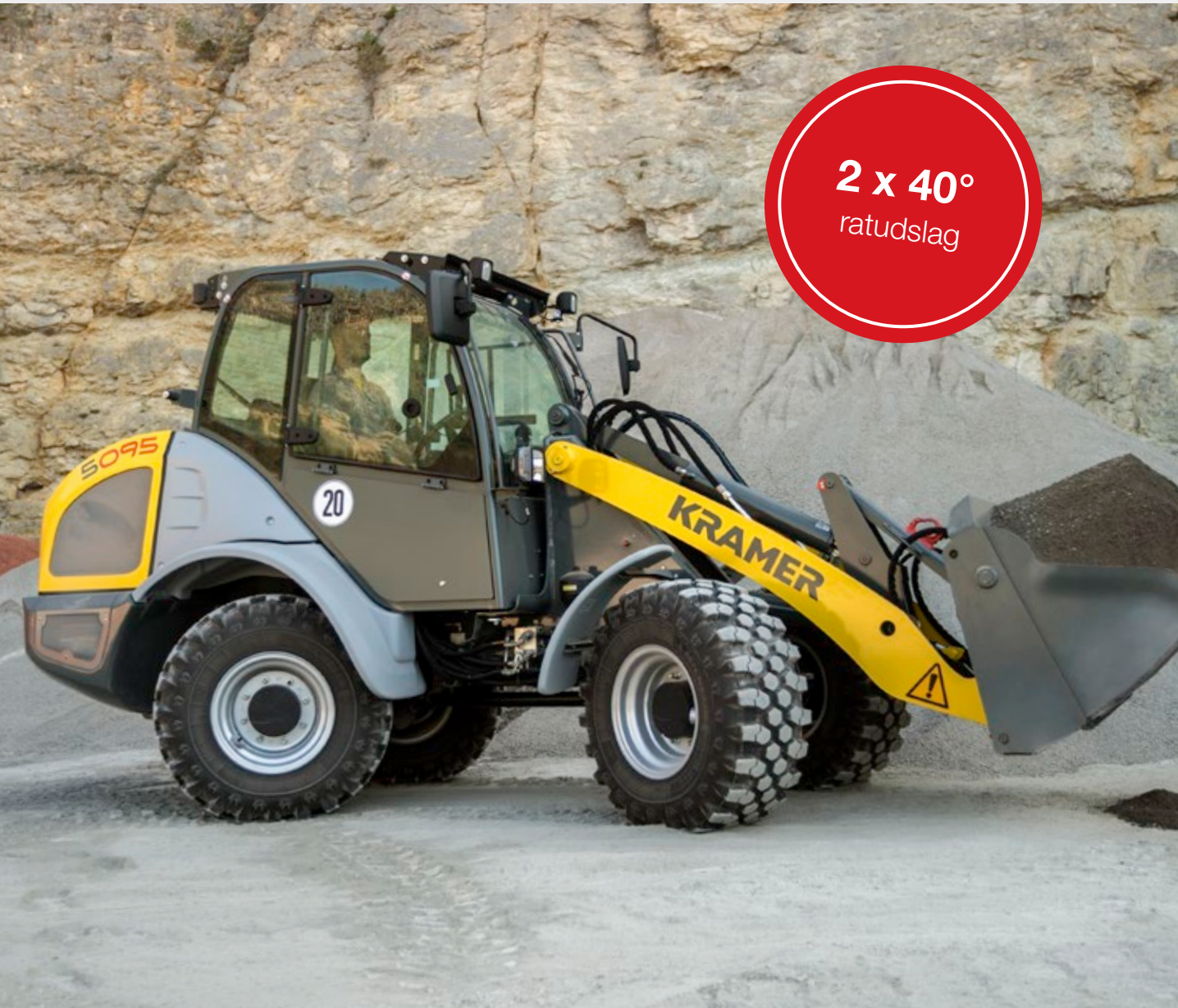
Firehjulsstyring særligt manøvreedygtig ved indskrænkede pladsforhold
