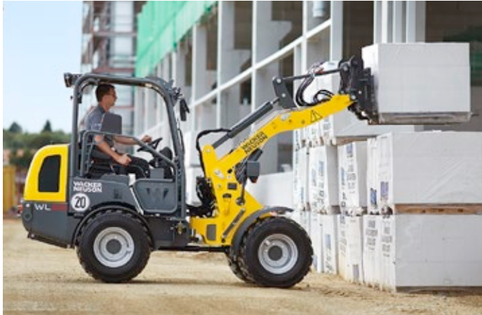
Spolehlivě i s těžkými břemeny: šířkově stavitelné paletové vidle.
