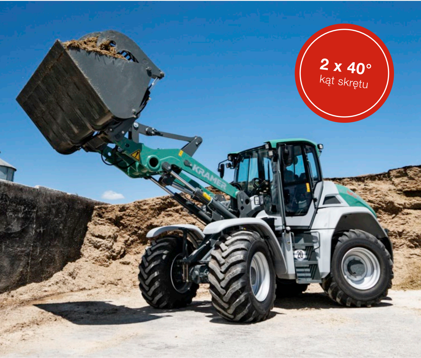
Ładowarka z czterema kołami skrętnymi jest szczególnie zwrotna w wąskich przestrzeniach
