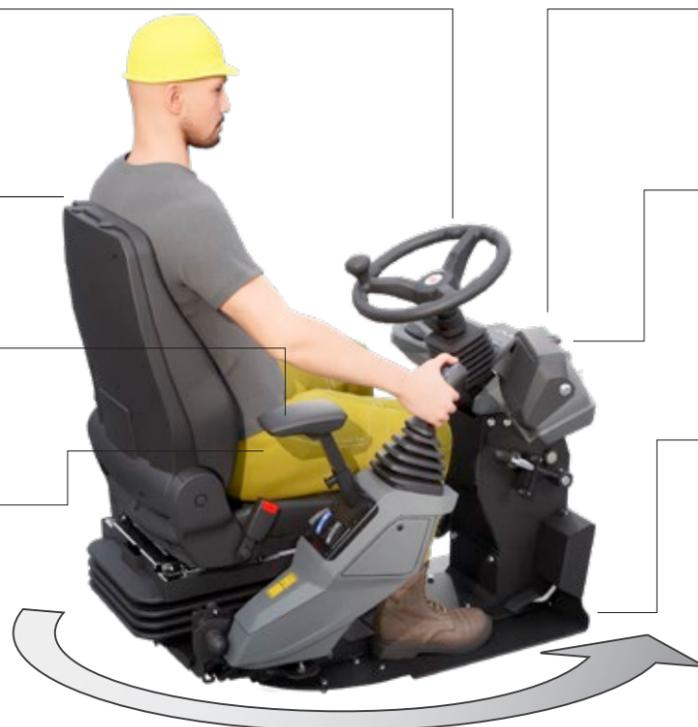
Display multifunzione per le funzioni della macchina incl. protezione del display con blocco
