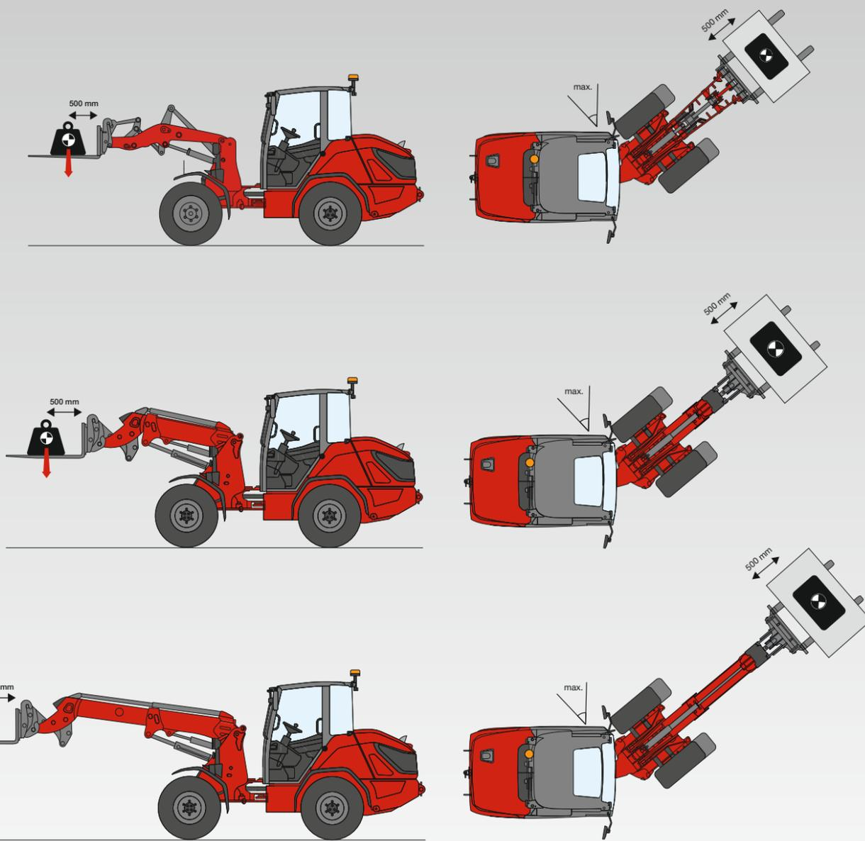
**Опрокидывающая нагрузка с вилочным захватом для поддонов, машина прямая или со сложенным шарнирным сочленением, подъемная рама горизонтальная**
