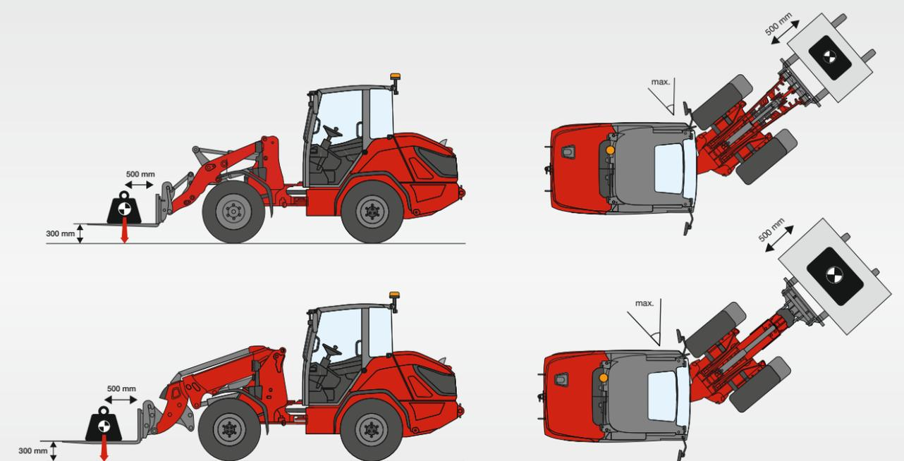
**Опрокидывающая нагрузка с вилочным захватом для поддонов, машина прямая или со сложенным шарнирным сочленением, транспортное положение**
