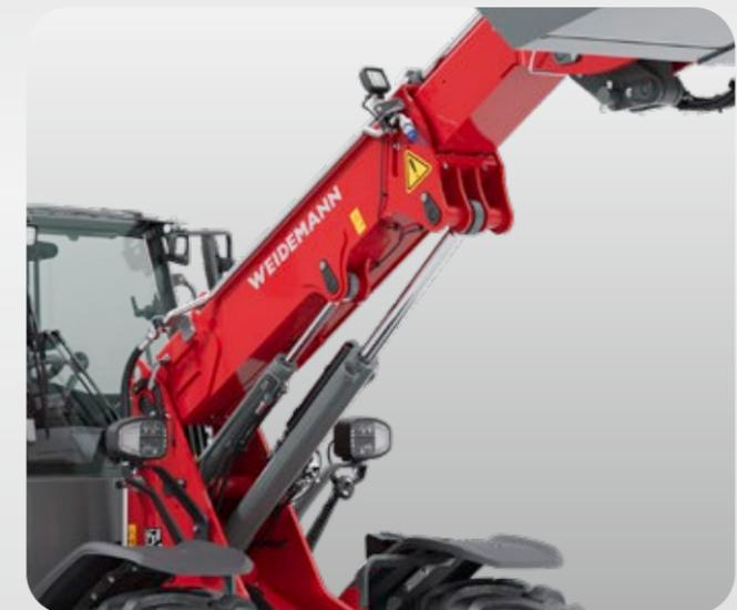
В больших гидравлических цилиндрах всегда имеется достаточный запас и компоненты погрузочного устройства не эксплуатируются на пределе своих возможностей. За счет этого увеличивается срок службы машины.
