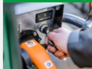
Accionar el interruptor de llave\* para iniciar el proceso de carga. El indicador del estado de carga situado en la parte trasera de la máquina comienza a parpadear.
