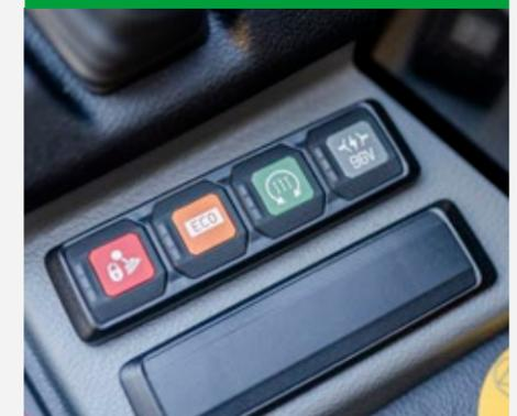
Hay dos modos de conducción para elegir: Eco y Auto (PWR). En el modo Auto, tiene a su disposición toda la potencia del motor y la velocidad de desplazamiento sin restricciones. En el modo ECO, la potencia del motor y la velocidad de desplazamiento están limitadas. Esto permite ahorrar energía y aumenta la duración.
