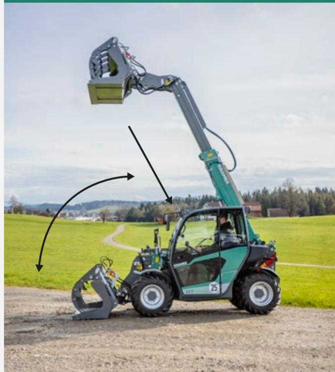
Al bajar el equipo de carga, el brazo telescópico se retrae de forma automática y lenta. Esto mantiene la carga lo más cerca posible del vehículo y no crea situaciones críticas, ni siquiera con las máximas cargas útiles. El modo cuchara es ideal para cargar materiales de relleno.
