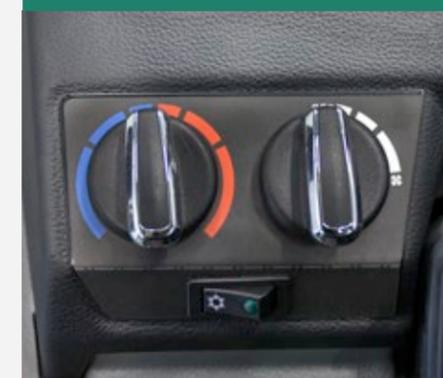
El sistema de calefacción y ventilación con ventilador, filtro de aire fresco y boquillas de aire bien ubicadas garantiza un entorno de trabajo agradable. En lugares con temperaturas exteriores especialmente altas, se recomienda el aire acondicionado opcional. Además, el vehículo está equipado con un parasol ajustable para trabajar sin deslumbramientos.
