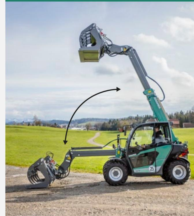
En modo manual, la máquina no realiza ningún movimiento automático del equipo de carga. Por supuesto, la protección contra sobrecarga todavía está activa y detiene el equipo de carga tan pronto como se alcanza el límite de sobrecarga. En este punto, solo se permite retraer y elevar el sistema de carga.
