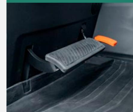
Los pedales suspendidos permiten un manejo preciso incluso con un número de revoluciones elevado en el motor. Además, el suelo de la cabina se puede quitar y limpiar fácilmente.
