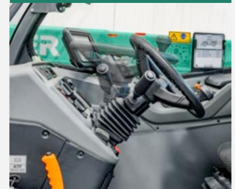
La columna de dirección se puede regular en inclinación y altura para adaptarse a las necesidades del operador. El volante de dirección se puede mover hacia delante y hacia atrás presionando la palanca hacia abajo. Al tirar de la palanca, se ajusta la altura del volante de dirección. Además, el volante de dirección está recubierto de un material de alta calidad y antideslizante.
