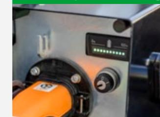
El indicador del nivel de carga se ilumina permanentemente cuando el proceso de carga finaliza automáticamente.
