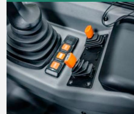
El modo de conducción Pedal/CSD permite ajustar el número de revoluciones óptimo de la máquina y el implemento, así como la velocidad de trabajo adecuada. Posteriormente, ambos valores se pueden ajustar a la situación de trabajo en cualquier momento mediante un interruptor de accionamiento o un regulador deslizante. Esto permite unas aplicaciones de trabajo constantes y, al mismo tiempo, cómodas.
