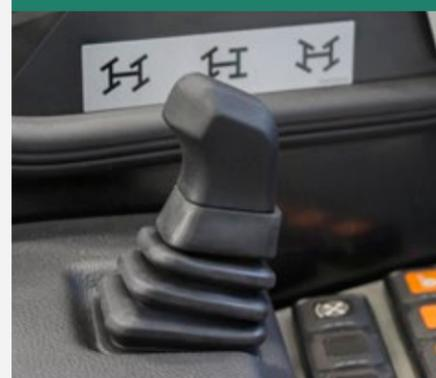
Se puede cambiar entre los tipos de dirección con la palanca de mando del tablero. Ya sea dirección a las cuatro ruedas, delantera o tipo «cangrejo», hay el tipo de dirección adecuado para cada aplicación.
