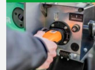
Abir la consola de carga y conectar el cable de carga a la máquina.
