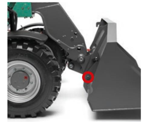
**Enganche rápido hidráulico (opcional) – El sistema de acople rápido de Kramer:** acercarse al implemento, recogerlo desde el asiento del operador y bloquearlo de forma hidráulica pulsando un botón de ruedecilla en el joystick. El cilindro de bloqueo se encuentra fuera del punto de giro de la placa de acople rápido y, por tanto, fuera de la zona donde puede ensuciarse.
