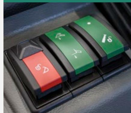
Mediante la identificación de los interruptores por colores, se puede reconocer rápidamente cada grupo de funciones. Rojo = seguridad, verde = hidráulica, azul = conducción y gris = sistema eléctrico. De este modo se garantiza al conductor un manejo cómodo y seguro sin riesgo de confusión. El resultado es una mayor eficiencia en el trabajo.
