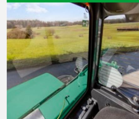
Los postes estrechos de la cabina y el acristalamiento panorámico permiten una excelente visibilidad desde todos los lados de la cabina. El parabrisas panorámico contribuye a una buena visión general y mejora el confort en la conducción. La tapa plana de la batería garantiza una visibilidad óptima hacia el lado derecho, de la rueda trasera derecha y el guardabarros.
