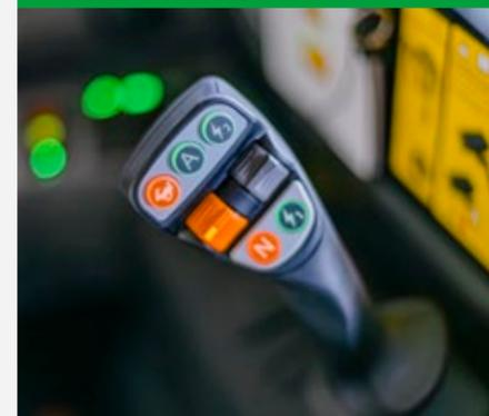
Con el joystick multifuncional el operador lo tiene siempre todo bajo control. Además de las funciones principales de elevación y descenso, así como de inclinación hacia dentro y hacia fuera, todas las funciones importantes se encuentran en el joystick, entre ellas, la selección de la dirección de marcha. Asimismo, los elementos de mando del joystick disponen de retroiluminación por la noche, lo que garantiza un manejo seguro de la máquina incluso en la oscuridad.
