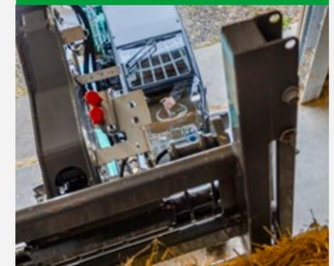
La rejilla FOPS (Falling Object Protective Structure) está instalada en el interior para mantener la altura del vehículo lo más baja posible. El diseño de la rejilla FOPS proporciona una visibilidad óptima del sistema de carga elevado. Además, se puede pedir de forma opcional un radio con puerto USB, reproducción por Bluetooth, DAB+ y dispositivo de manos libres.
