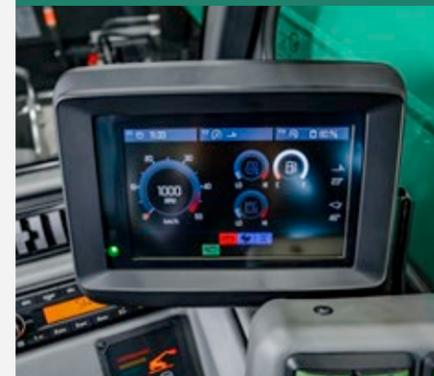
El display opcional de 7 pulgadas permite al operador echar un vistazo a los datos actuales de la máquina en cualquier situación. Asimismo, ofrece numerosas funciones adicionales, como el ajuste de la sensibilidad del joystick, la velocidad de activación del estabilizador de carga, el intervalo de tiempo ajustable para el ventilador reversible y el ajuste de la cantidad de aceite para circuitos de control adicionales.
