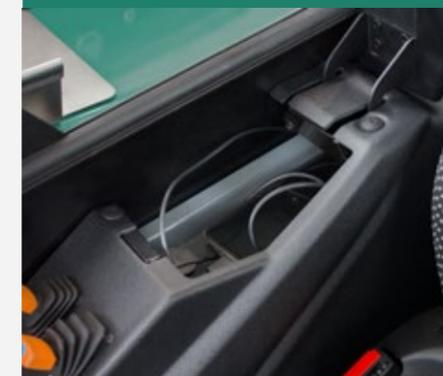
El reposabrazos del modelo KT144 de Kramer no solo proporciona un confort adicional: debajo del respaldo abatible hay un práctico compartimento de almacenamiento con una toma de carga USB, en el que, por ejemplo, se puede guardar y cargar el smartphone al mismo tiempo.
