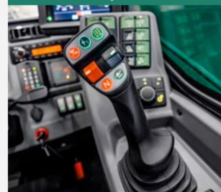
El joystick con control piloto electrónico permite un trabajo extremadamente sensible y preciso y la integración de sistemas de asistencia para el conductor, como Smart Handling, que ayuda aún más al conductor. Los diversos pulsadores y ruedecillas se iluminan de color en el innovador diseño nocturno.
