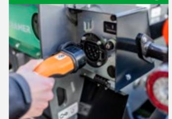
Accionar el interruptor de llave\* y retirar el enchufe de carga. A continuación, cerrar la consola de carga.
