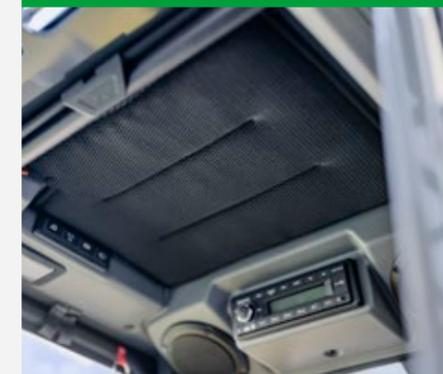
La máquina está equipada de serie con calefacción en las ventanillas de la cabina. Para lograr la mayor eficiencia energética posible para el sistema de calefacción general, además de la calefacción de aire normal, la cabina puede equiparse con una calefacción de superficie adicional. Se encuentra en el techo de la cabina y emite calor de forma focalizada. La calefacción de aire de serie también se puede utilizar como calefacción auxiliar durante el proceso de carga.
