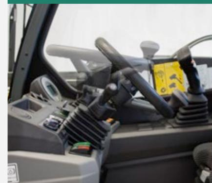
La columna y el volante de dirección se pueden ajustar individualmente según los requisitos del operador, tanto en altura como en inclinación. El conductor también tiene más espacio al entrar y salir. Además, el volante de dirección está hecho de un material de alta calidad y antideslizante.
