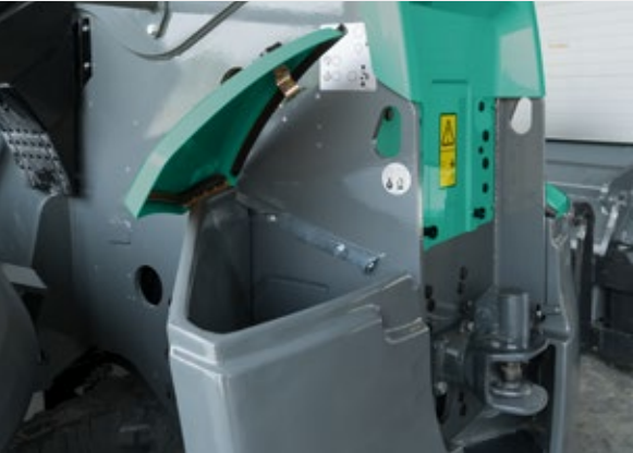
Compartimento de armazenamento nos pesos traseiros para KT457 - KT559
