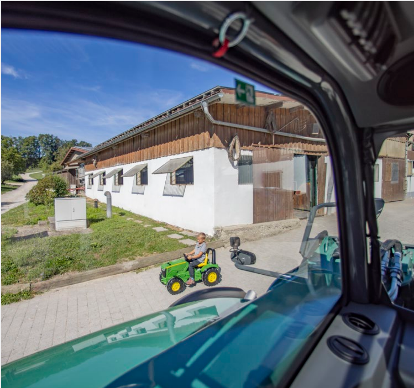
A cobertura de motor plana garante uma visibilidade perfeita para o lado direito.
