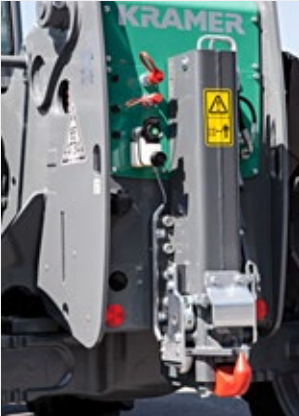
Compartimento de armazenamento nos pesos traseiros para KT457 - KT559
