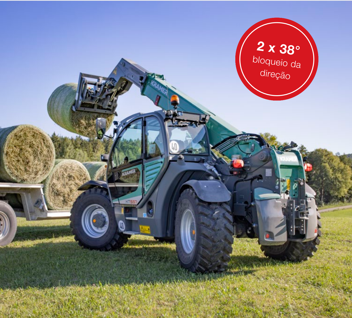
Direção em todas as rodas para máxima manobrabilidade
