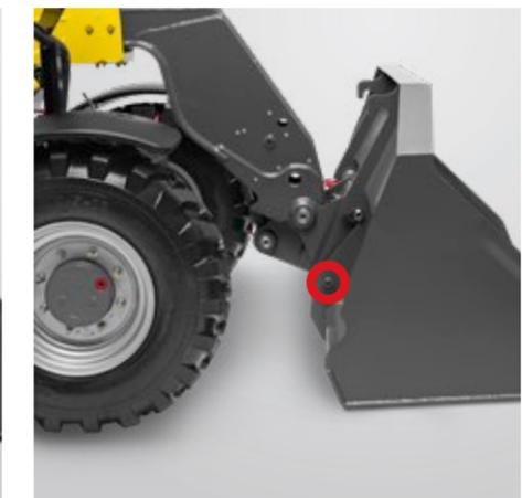
**Changer d'équipement hydraulique (en option) - le système d'attache rapide Kramer :** s'approcher de l'accessoire, prendre l'accessoire depuis le siège du conducteur et le verrouiller hydrauliquement à l'aide du bouton-poussoir à roulette du joystick. Le vérin de verrouillage se trouve en dehors du point de rotation de l'attache rapide ; il n'est donc pas situé dans la zone de salissure.
