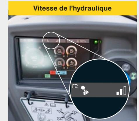
La vitesse du système hydraulique de travail peut être ajustée à trois niveaux via l'écran et le Jog Dial pour l'élévation et l'abaissement du bras de levage ainsi que le basculement des équipements. Ainsi, l'opérateur peut toujours trouver le bon équilibre entre vitesse et précision.
