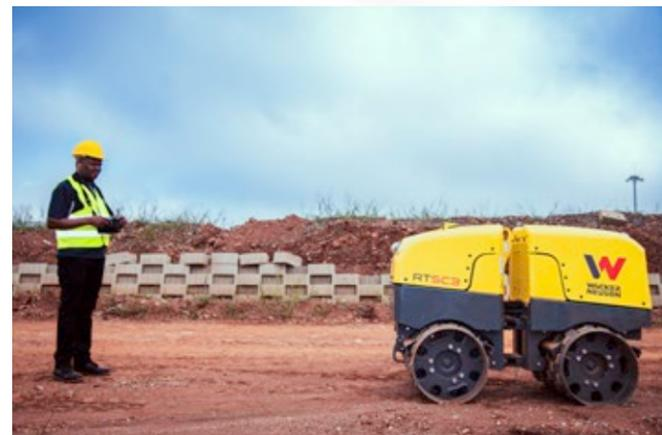
**Seguridad del operador:** un sensor de proximidad entre el operador y la máquina desactiva automáticamente la máquina en un área de 2 metros.
