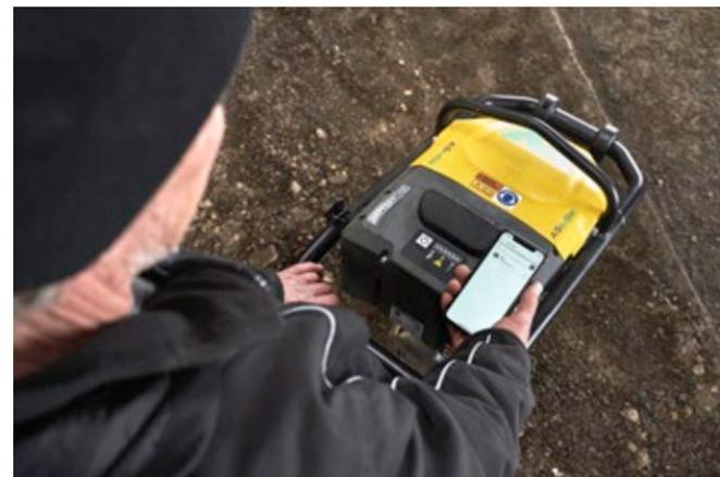
Aplicación Battery One: información sobre el uso y el estado de la batería, y cómoda actualización del software a través de un smartphone.
