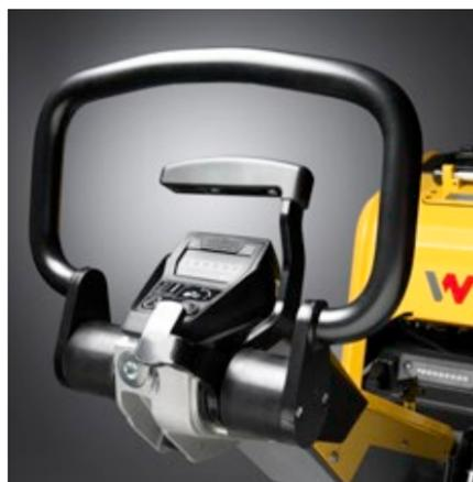
La palanca ergonómica del acelerador está bien protegida en el centro de la empuñadura de guía.
