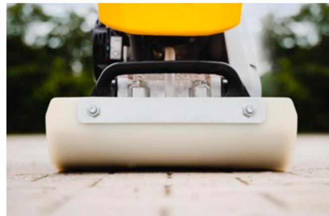
La placa de deslizamiento (accesorio) protege las superficies pavimentadas sensibles a las vibraciones. Con solo dos pernos, se fija rápidamente a la máquina.
