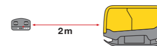
Detección inteligente del área de seguridad: la máquina se detiene automáticamente si la distancia mínima de seguridad entre el usuario y la máquina es inferior a los 2 m.
