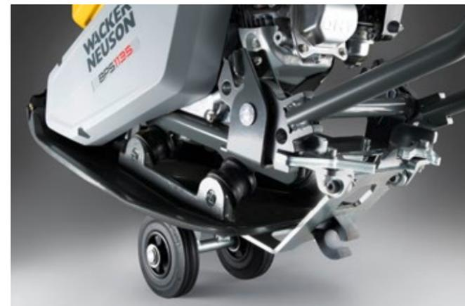
El juego de ruedas (accesorio) se puede montar con facilidad. Cuando se pliega, el manillar de guía se bloquea automáticamente y, cuando se despliega, se desbloquea.
