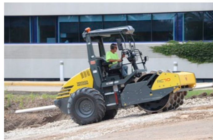
El control de tracción garantiza que las ruedas no giren en vacío incluso en terrenos irregulares.
