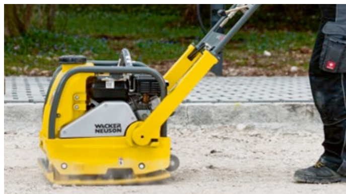
Excelente maniobrabilidad: gracias a la forma especial de la placa base de la WPU1550.
