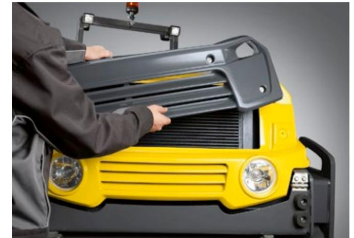
**Fácil limpieza del radiador** gracias a la tapa desmontable por separado.
