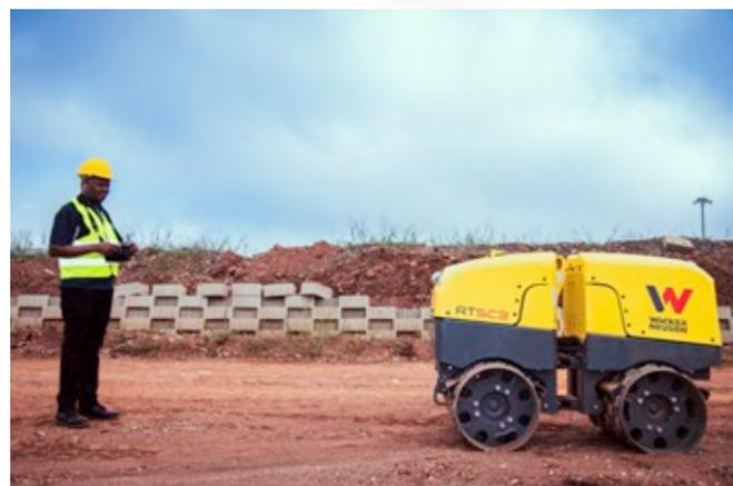
**Seguridad del usuario:** un sensor de proximidad entre el operador y la máquina desactiva automáticamente la máquina en un rango de 2 metros.
