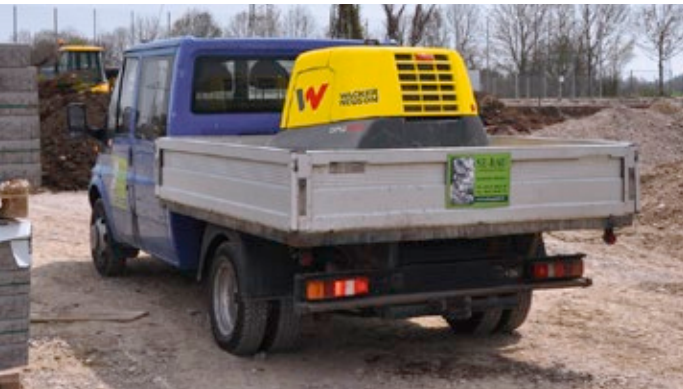
Dieplader overbodig: de DPU130r weegt slechts 1.200 kg en kan op een bus of lichte vrachtwagen getransporteerd worden.
