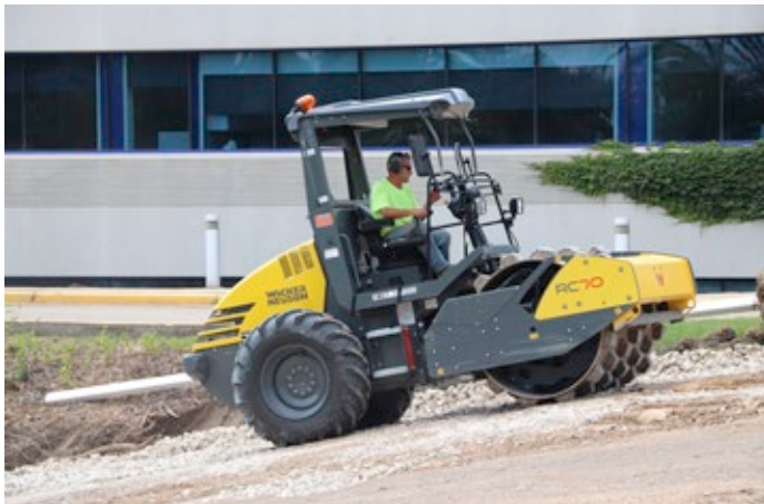
De tractieregeling zorgt ervoor dat de wielen ook op oneffen terrein niet wegslijpen.
