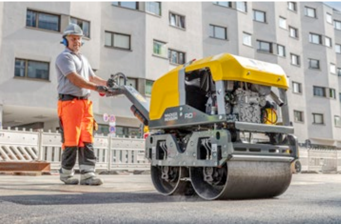
De lange handgreep vergemakkelijkt sturen en draaien, in het bijzonder op kleine oppervlakken.
