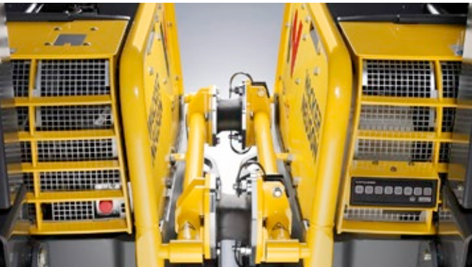
Stabiele koppeling: met enkele schroeven snel en betrouwbaar verbonden.
