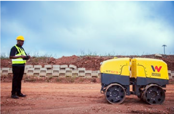
Veiligheid van de bediener: een nabijheidssensor tussen de bediener en de machine deactiveert de machine automatisch binnen een bereik van 2 meter.
