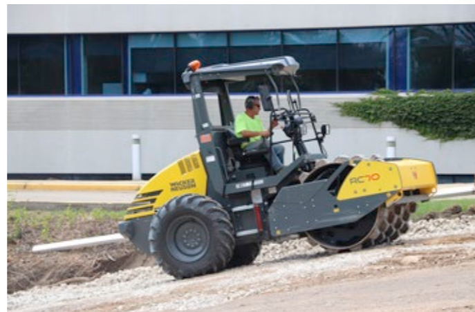
Traktionskontrollen forhindrer slip på hjulene - også i ujævnt terræn.
