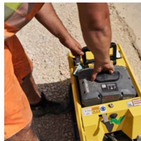
Batteriskift udføres med få håndgreb.
