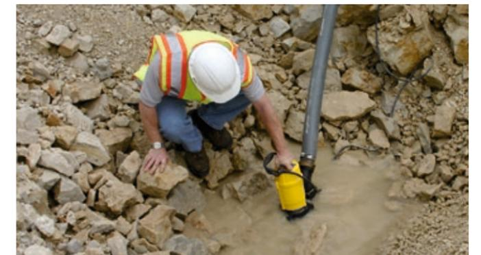
**Bombas sumergibles eléctricas con protección contra marcha en seco:** incluso en caso de marcha intermitente por falta de agua gracias al distribuidor de aceite integrado.
