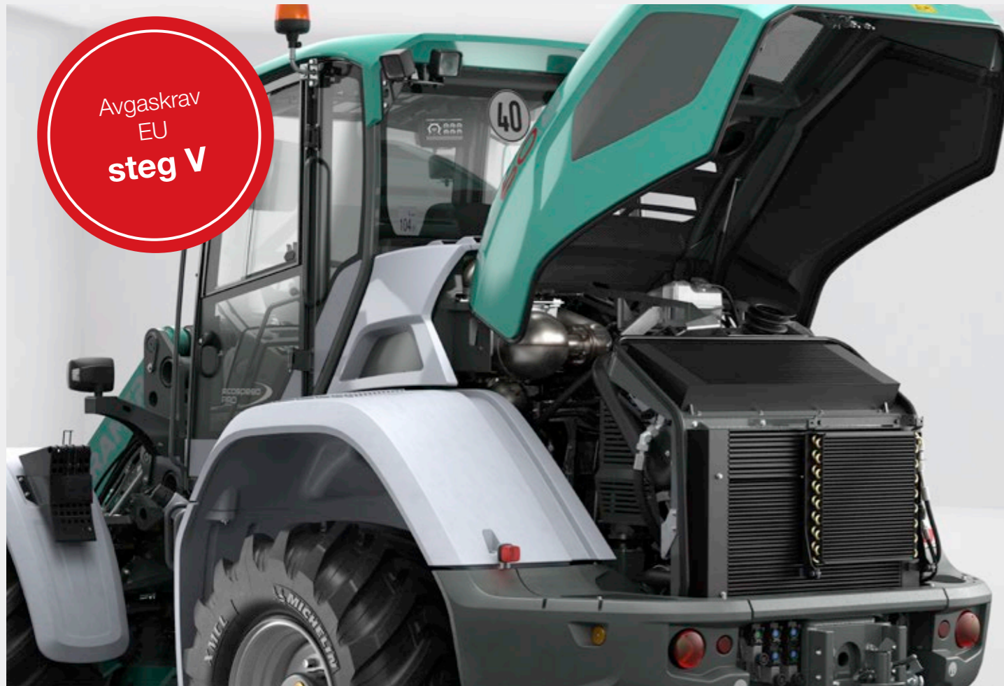
Vattenkyld fyrcylindrig rak motor med kyld extern avgasretur, turboladdning och intercooler.
