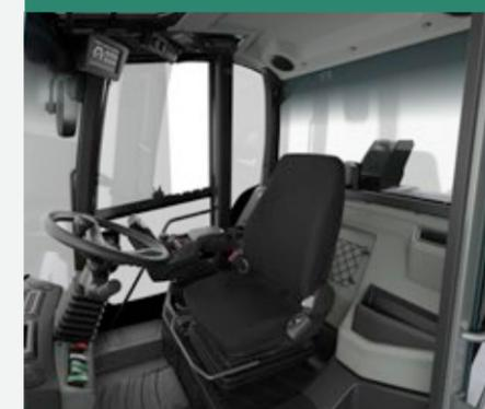
Grazie al design della cabina, l'operatore viene protetto dalle emissioni acustiche (70 dB(A)). Inoltre il climatizzatore automatico, i fari di lavoro e il tergilunotto vengono comandati lateralmente sopra il display da 7 pollici. Altre caratteristiche della cabina sono: Radio Bluetooth con dispositivo viva voce, presa da 12 V con cappa di protezione, due attacchi USB e molto altro.
