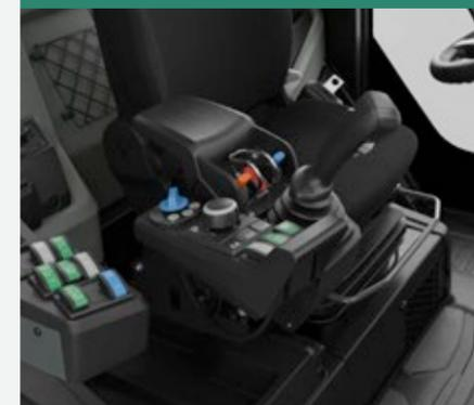
La cabina è dotata del cosiddetto Jog Dial. In questo modo è possibile regolare comodamente tutte le impostazioni importanti della macchina come, ad esempio, la quantità d'olio dei singoli circuiti idraulici. I più importanti dati di esercizio possono essere visualizzati e adattati alle esigenze del conducente con la rotella di rotazione e pressione.
