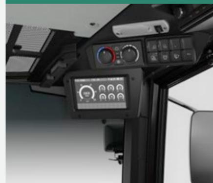
Le macchine con un principio di funzionamento completamente nuovo sono dotate di un ampio display LCD da 7 pollici. La struttura del display da 7" è semplice e intuitiva. Tutti i dati e le funzioni rilevanti del veicolo vengono visualizzati nel menu principale. La luminosità può essere regolata e personalizzata in base alle proprie esigenze.
