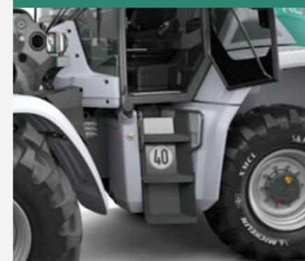
La cabina è perfettamente raggiungibile grazie all'ampia area di salita dai due lati contro gradini disposti a scala. Quattro maniglie (una a sinistra sul montante A, due sulla scaletta e una sulla porta) consentono una salita e una discesa sicura su entrambi i lati. È presente anche l'illuminazione interna con interruttore a contatto nel sedile.
