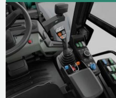
Il bracciolo, con console del joystick e Jog Dial, è montato sul sedile dell'operatore e dotato dei più importanti elementi di comando. In questo modo la mano sinistra può rimanere sul volante e la mano destra nell'area del bracciolo. Il bracciolo è ribaltabile verso l'alto e rende quindi possibile l'uscita anche verso destra.
