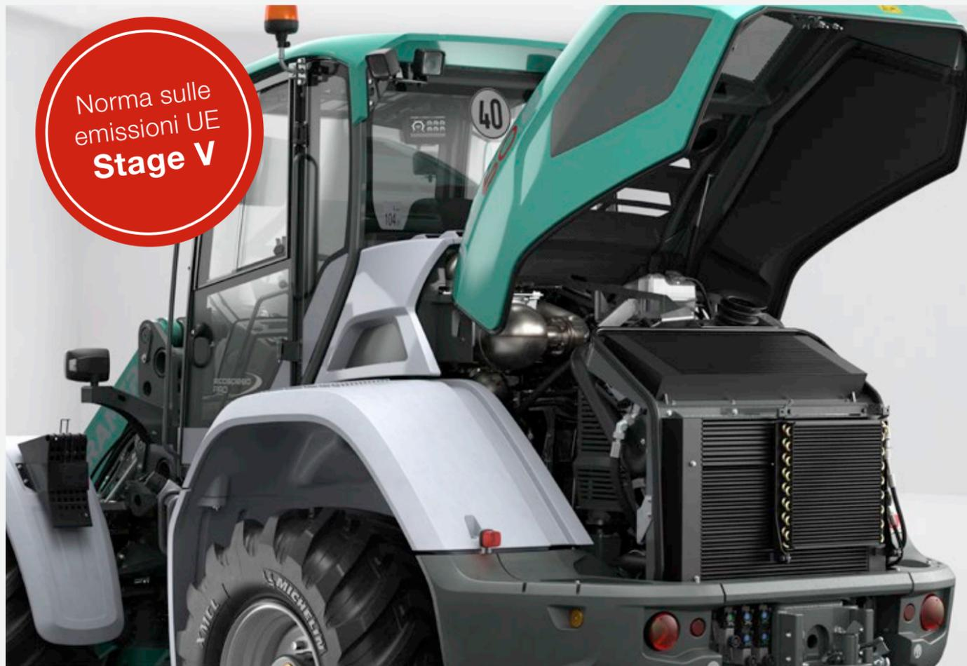
Motore in linea a 4 cilindri raffreddato ad acqua con recupero gas di scarico raffreddato esternamente, sovralimentazione e intercooler.
