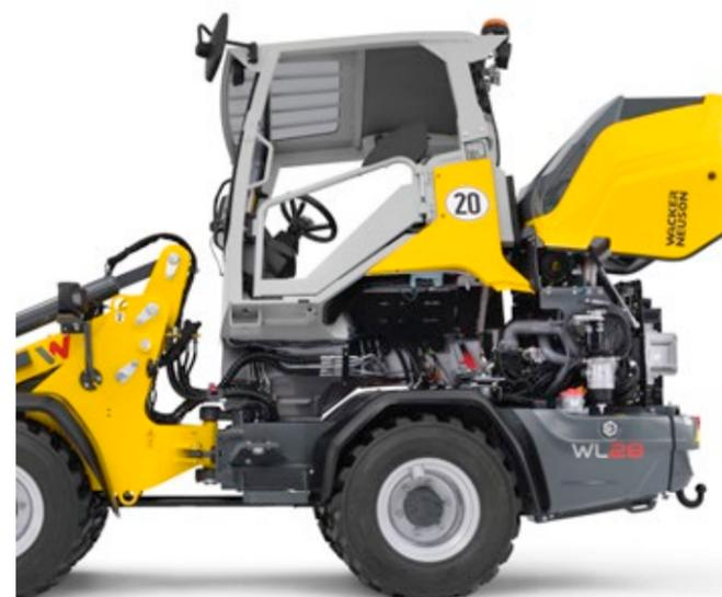
Los modelos WL20, WL25 y WL28 están equipados con un puesto del operador abatible y una cabina plegable. Esto permite acceder al motor, el sistema hidráulico y la electrónica. El capó del motor se puede abrir ampliamente, permitiendo un acceso óptimo.
