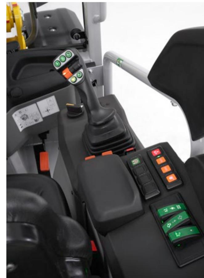
Conduzca de forma más inteligente con la WL28. El accionamiento de marcha con control electrónico garantiza un confort en la conducción muy alto y aumenta la fuerza de empuje de la máquina. Además, hay varios modos de desplazamiento disponibles.
