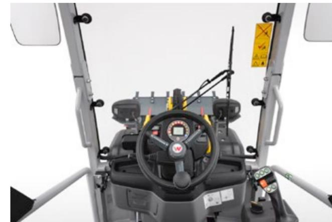
El diseño del sistema de carga garantiza una visibilidad perfecta en todas las direcciones. Tanto la cabina como el techo de protección para el operador ofrecen una excelente visibilidad del área de trabajo inmediata.
