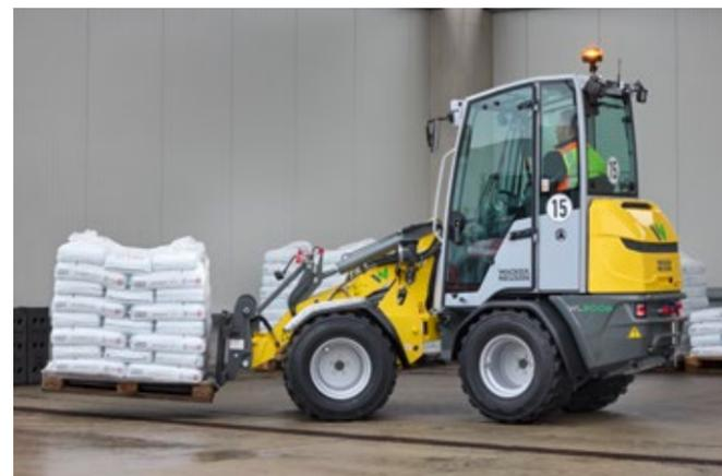
Fiable, incluso con cargas pesadas: horquilla para palés de anchura ajustable.
