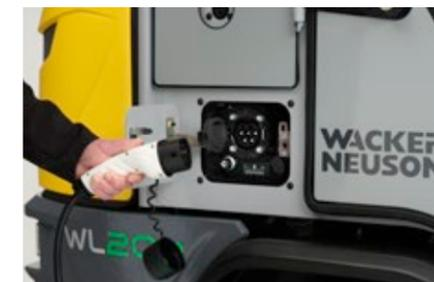
2. Abra la tapa de carga e inserte el enchufe tipo 2 en la máquina.
