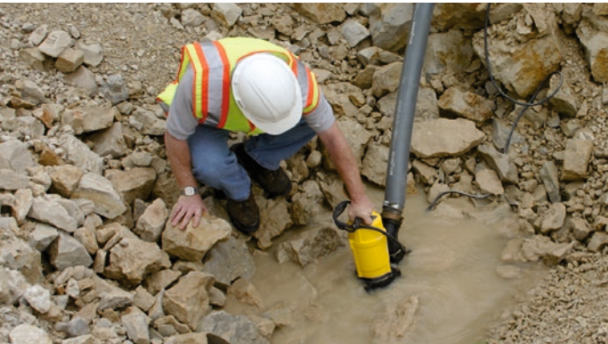
Tørrkjøringssikre nedsenkbare elektriske pumper: også ved vekslende tørrkjøring over tid takket være integrert oljefordeler.
