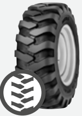
Bouwmachineprofiel – Mitas KL12.5, KL14.5
