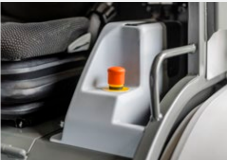
Snel toegankelijke noodstopschakelaar, waarmee de machine in geval van nood onmiddellijk in een veilige stand kan worden gezet.
