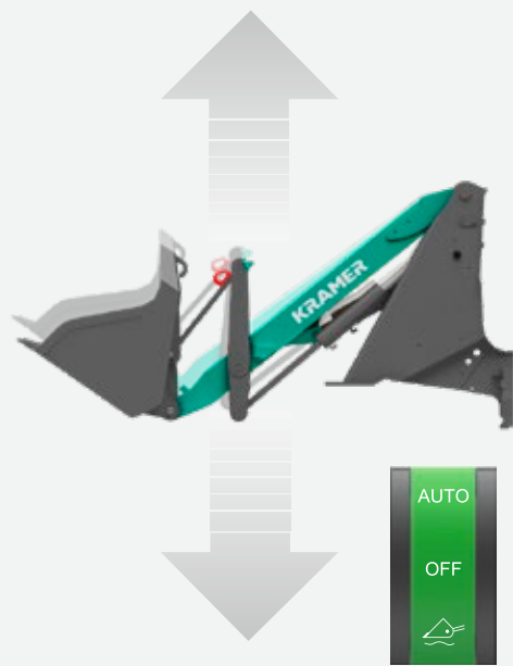
Automatische laststabilisator voorkomt het schommelen van de machine en reduceert materiaalverlies.
