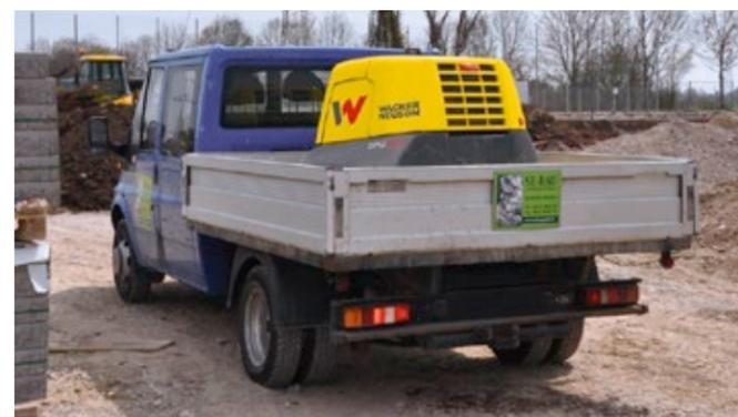
**Plus besoin d'une semi-remorque :** la DPU130r ne pèse que 1 200 kg et peut être transportée sur la surface de chargement d'un camion.
