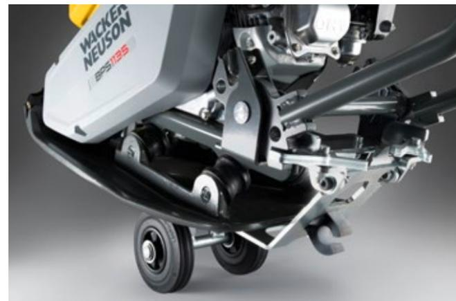
Le jeu de roues (accessoire) est facile à monter. Lorsqu'il est rabattu, le guidon se verrouille automatiquement. Il se déverrouille lorsqu'il est de nouveau relevé.
