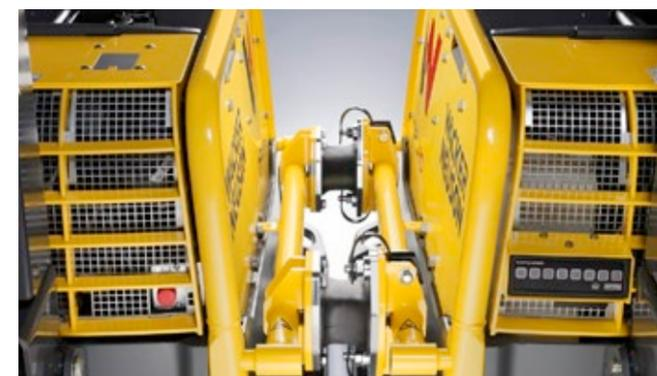
**Attelage stable :** couplage rapide et fiable avec quelques vis.
