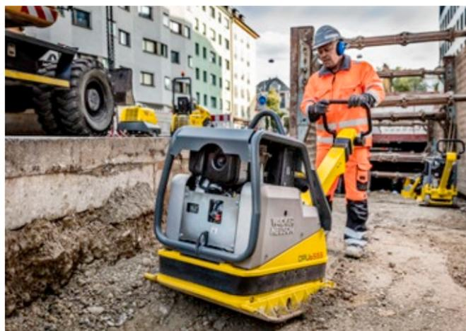
**En totale sécurité :** si vous lâchez le guidon, l'appareil compactera sur place.
