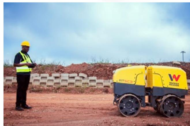
**Sécurité de l'opérateur** : un capteur de proximité entre l'opérateur et la machine désactive automatiquement la machine dans un rayon de 2 mètres.
