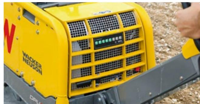
Le système de contrôle de compactage Compatec signale à l'opérateur le moment où le meilleur compactage possible avec un appareil est atteint. Cela évite de réaliser des passages superflus et assure un gain de temps.
