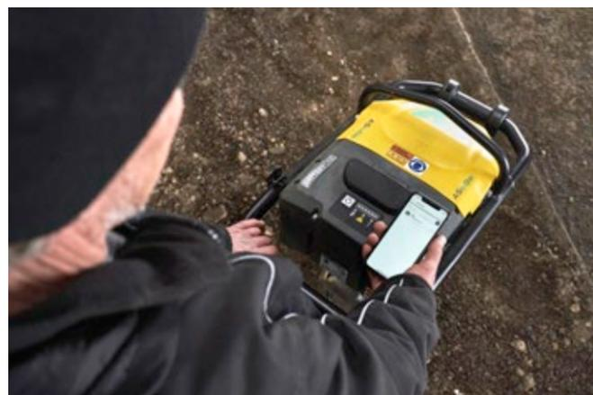
Application Battery One – Obtenir confortablement des informations sur l'utilisation de la batterie, l'état de la batterie et les mises à jour logicielles sur smartphone.
