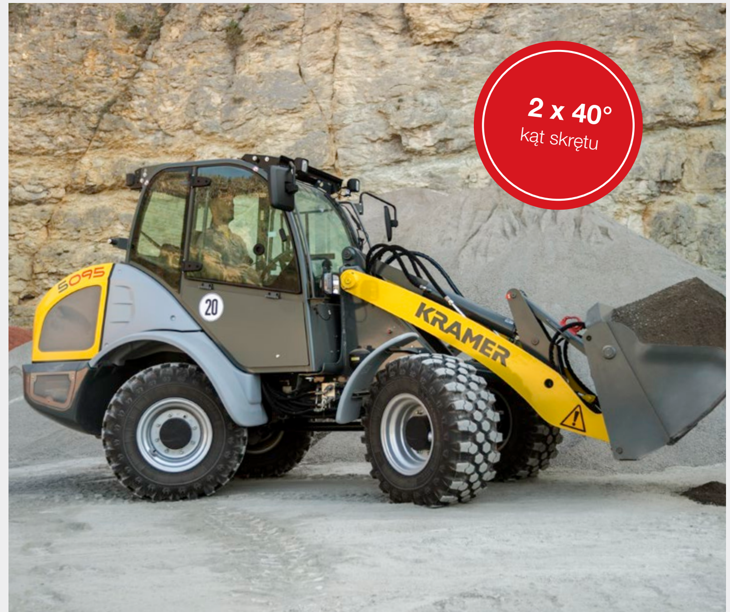
Ładowarka z czterema kołami skrętnymi jest szczególnie zwrotna w wąskich przestrzeniach
