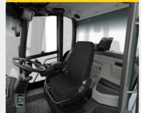
El diseño de la cabina protege al operador de las emisiones de ruido (70 dB[A]). Además, el sistema de aire acondicionado automático, las luces de trabajo y el limpiaparabrisas trasero se pueden controlar en el lateral, por encima del display de 7 pulgadas. Otras características de la cabina comprenden: radio Bluetooth con equipo de manos libres, conector de 12 V con capuchón de protección, dos conexiones USB, y mucho más.
