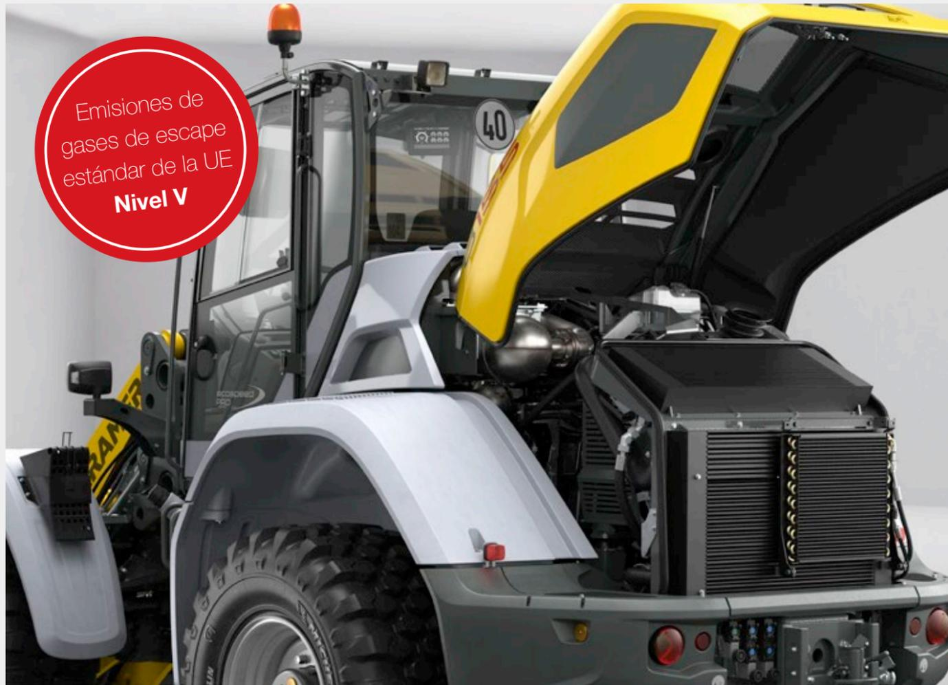
Motor en línea de cuatro cilindros refrigerado por agua con retorno de gases de escape externo refrigerado, turboalimentado y aire de sobrealimentación.
