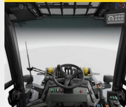
Las grandes zonas de acristalamiento combinadas con un techo de cristal de diseño abierto y la cámara de marcha atrás integrada ofrecen una excelente visibilidad panorámica en la nueva cabina: una visibilidad excelente del implemento, el lugar de trabajo inmediato y todos los alrededores de la máquina.
