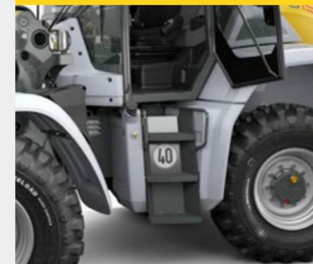
Se puede acceder fácilmente a la cabina por ambos lados a través de las zonas de entrada que gozan de un diseño amplio y tres escalones. Cuatro empuñaduras (una a la izquierda del pilar A, dos en el escalón de ascenso y una en la puerta) ofrecen una entrada y salida seguras en ambos lados. También está disponible con iluminación interior con un interruptor de contacto en la puerta.
