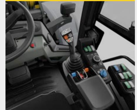
El apoyabrazos, que incluye la consola con palanca de mando y el disco selector, está fijado en el asiento del operador y equipado con los elementos de control más importantes. De este modo la mano izquierda puede permanecer en el volante de dirección mientras la derecha se queda en la zona del reposabrazos. El apoyabrazos se puede plegar para poder salir también por la derecha.
