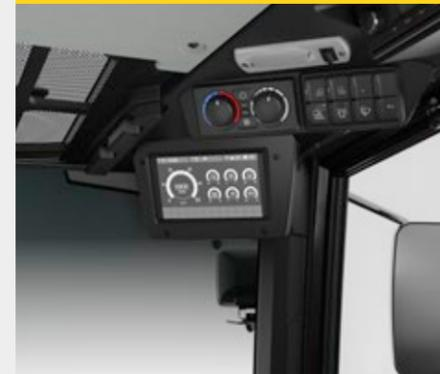
Las máquinas están equipadas con un concepto de manejo completamente nuevo, con un gran display LCD de 7 pulgadas. La configuración del display de 7" es sencilla e intuitiva. Todos los datos y funciones importantes del vehículo se muestran en el menú principal. El brillo se puede regular y personalizar conforme a sus necesidades.
