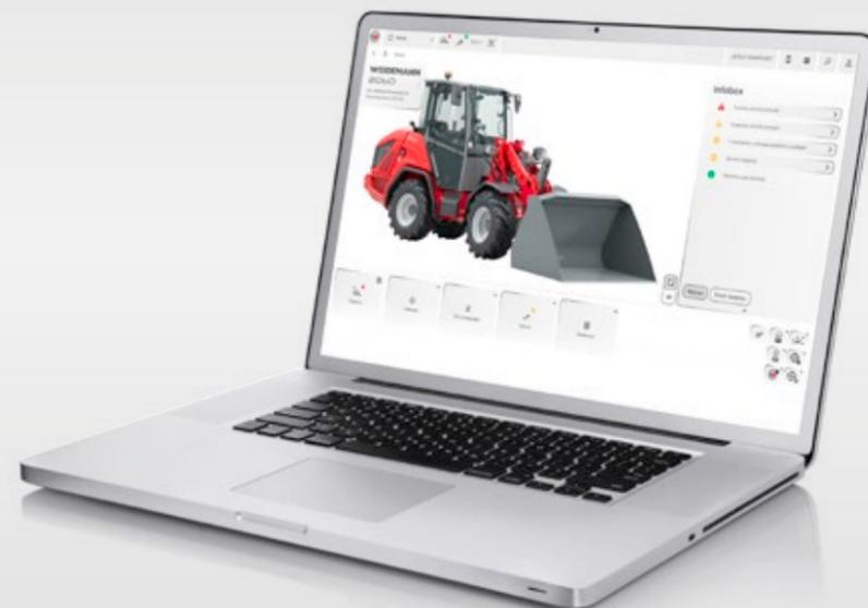
Grazie ai sistemi di diagnosi e analisi di Weidemann wedias ed Equip Inspector è possibile valutare in modo chiaro e rapido numerose funzioni, tra cui: la funzione di marcia, il 3° e il 4° circuito idraulico, i dati del motore così come le funzioni elettriche. I messaggi di guasto visualizzati sul display consentono all'operatore di individuare la soluzione più adatta.
