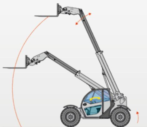
**Con vls.** Movimento quasi verticale. Spostamento minimo del momento del carico in direzione longitudinale della macchina.
