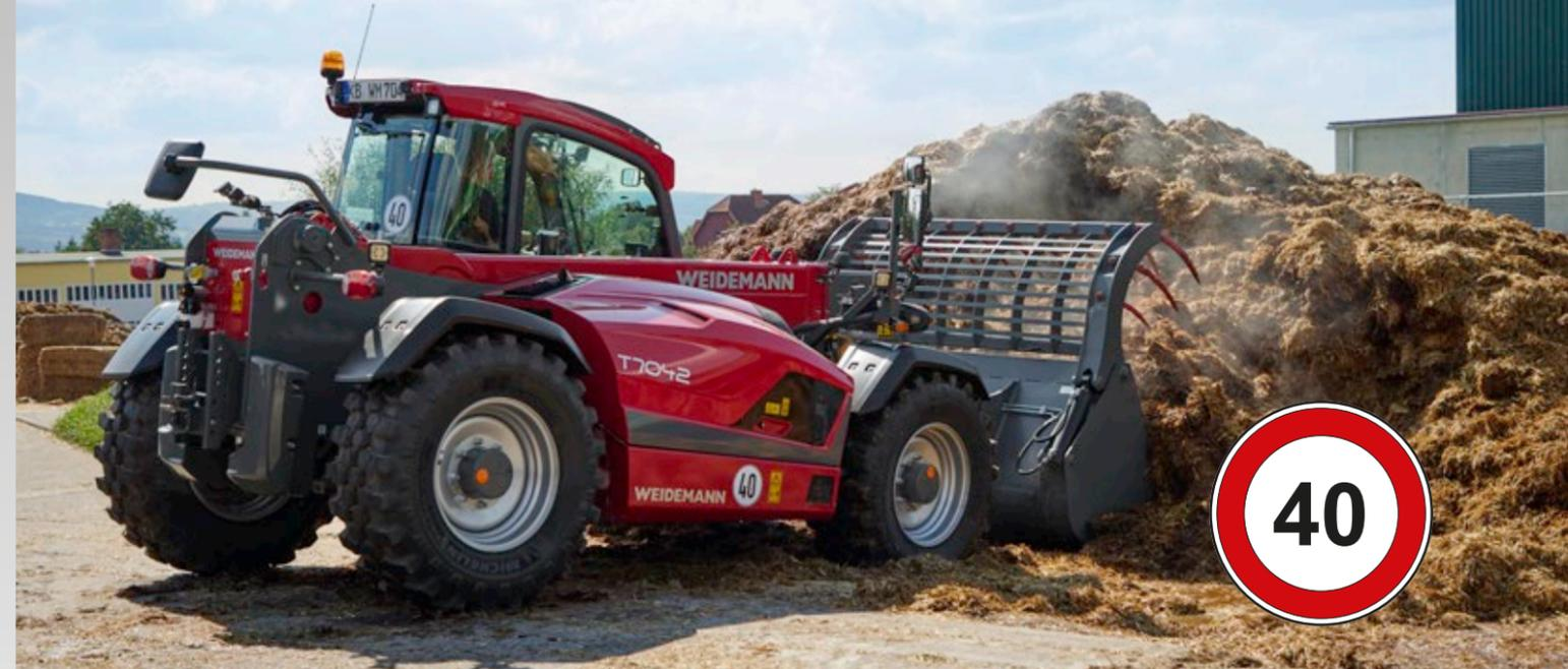
• Il Power Drive è una trazione idrostatica a variazione continua, che raggiunge forze di trazione e velocità di traslazione più elevate rispetto alle soluzioni precedentemente sviluppate. Ciò avviene mantenendo tutti i vantaggi delle precedenti trazioni in termini di compattezza, efficienza energetica e comfort dell'operatore.
