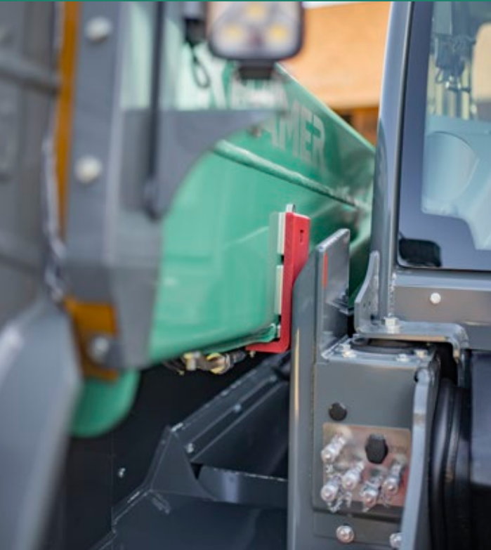
Zijdelingse geleiding van de laadinrichting
